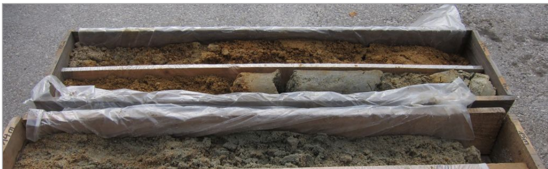
Abb. 2.1.2.22: Bohrung Gratz: 12,0-15,0 m – Roter Oxidationshorizont innerhalb der grauen Linz-Melk-Formation (Foto: M. Peresson).
