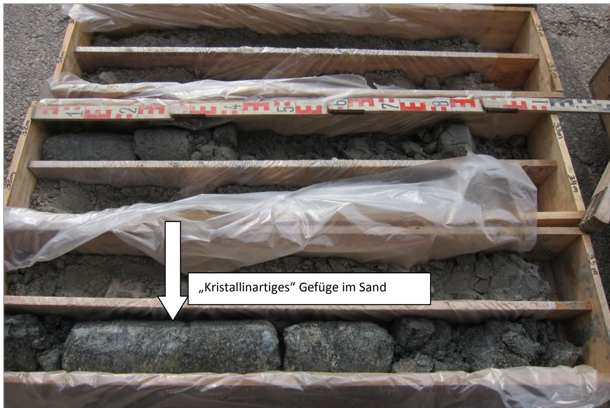
Abb. 2.1.2.26: Bohrung Gratz: 30,0-35,0 m – Grobsandige Linz-Melk-Formation mit „Kristallingefüge“ (Foto: M. Peresson).
