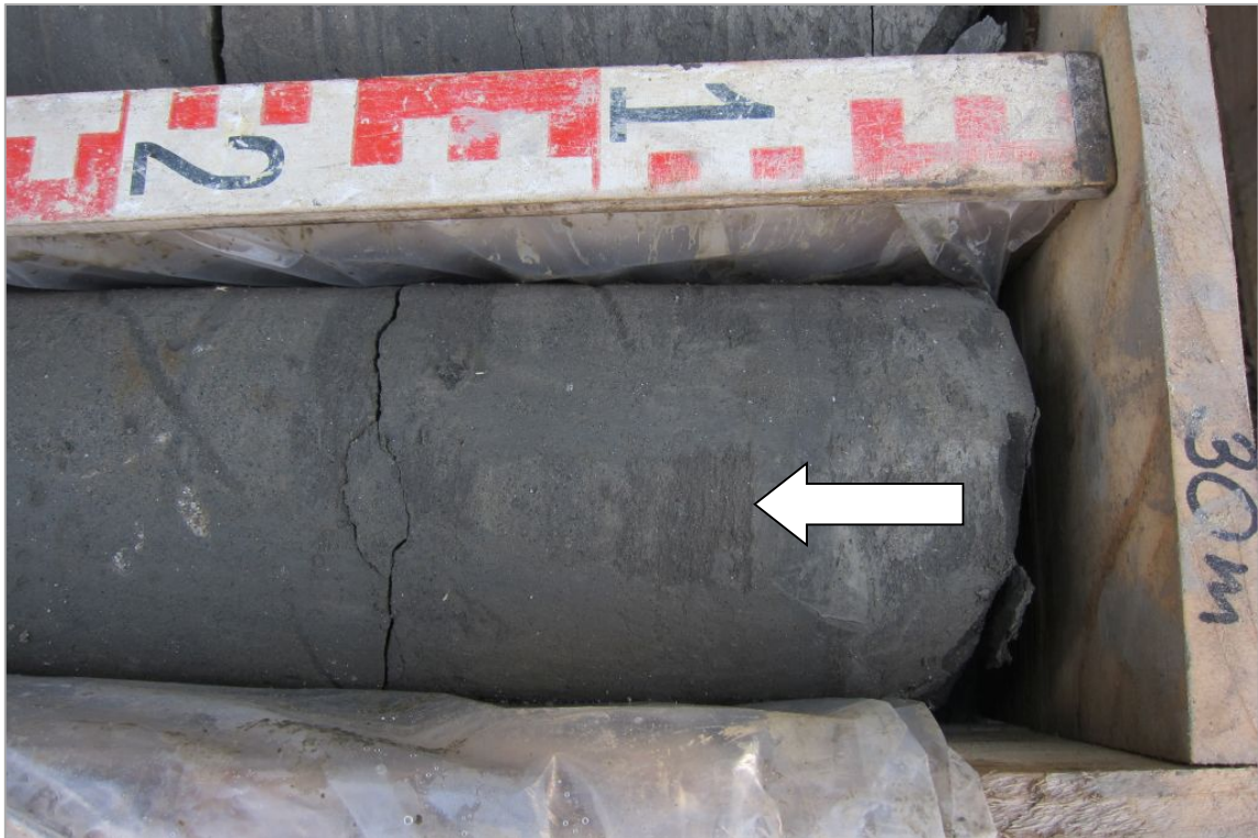
Abb. 2.1.2.13: Bohrung Niederthal: Eferding-Formation mit ebener Lamination (Foto: M. Peresson).
