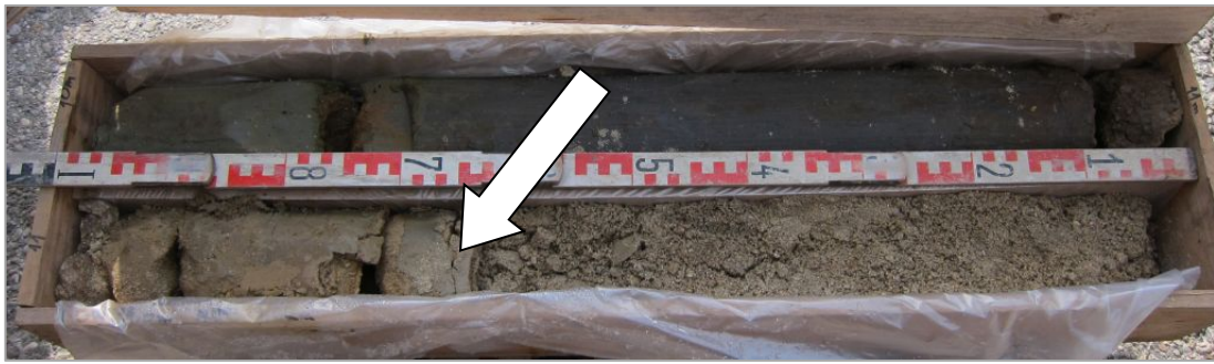
Abb. 2.1.2.21: Bohrung Gratz: 10,0-12,0 m – Übergang von der pelitreichen Eferding-Formation zur sanddominierten Linz-Melk-Formation (Pfeil) (Foto: M. Peresson).
