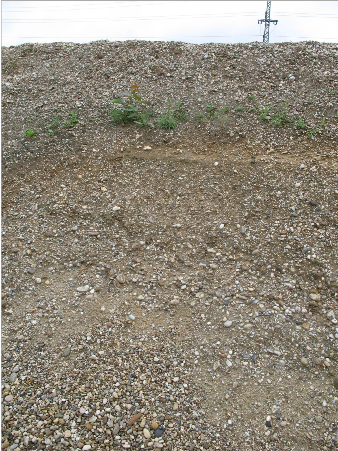
Abb. 2.3.3.10.: Südostseite im Baustellenbereich Linz (Punkt 276_14): Unsortierte, „chaotische“ Niederterrassenkiese (Foto: Ch. Rupp).
