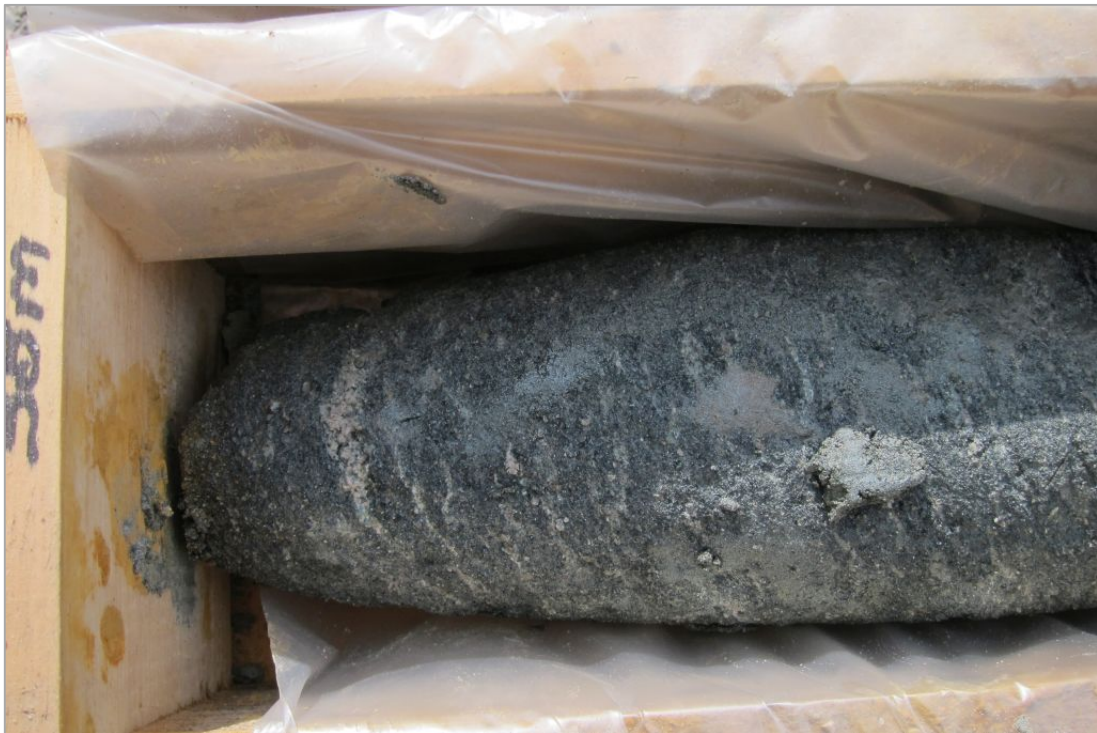
Abb. 2.1.2.28: Bohrung Gratz: 38,0 m – Grobsandige Linz-Melk-Formation mit „Kristallgefüge“ (Foto: M. Peresson).
