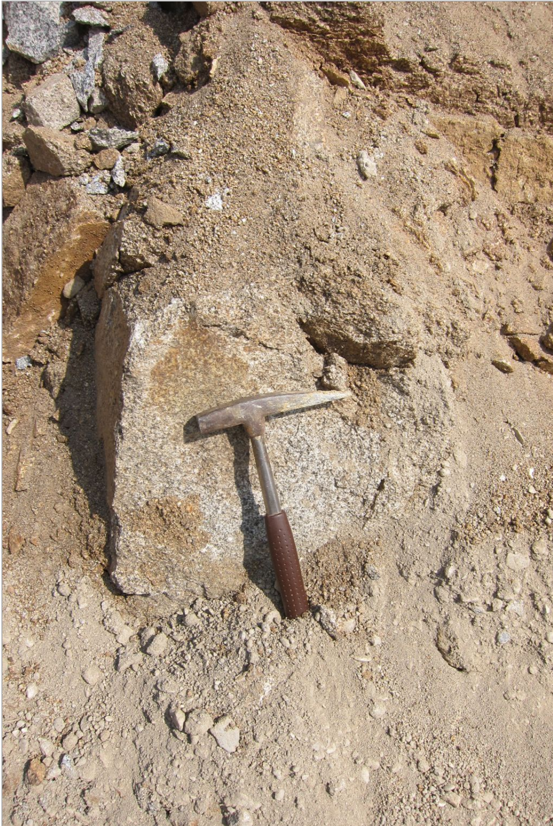
Abb. 2.1.1.37.: Bereich Freistadt Nord: Feinkörniger, stark verwitterter Freistädter Granodiorit (Foto: M. Peresson).
