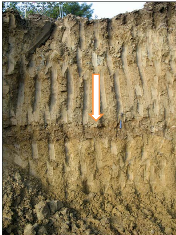
Abb. 2.3.1.7: Kieslinse im quartären Schluff (Foto: Ch. Rupp).
