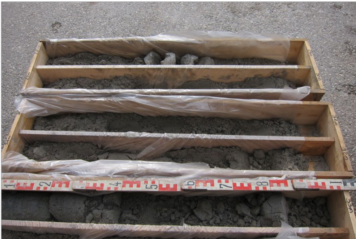
Abb. 2.1.2.25: Bohrung Gratz: 28,0-33,0 m – Grobsandige Linz-Melk-Formation (Foto: M. Peresson).
