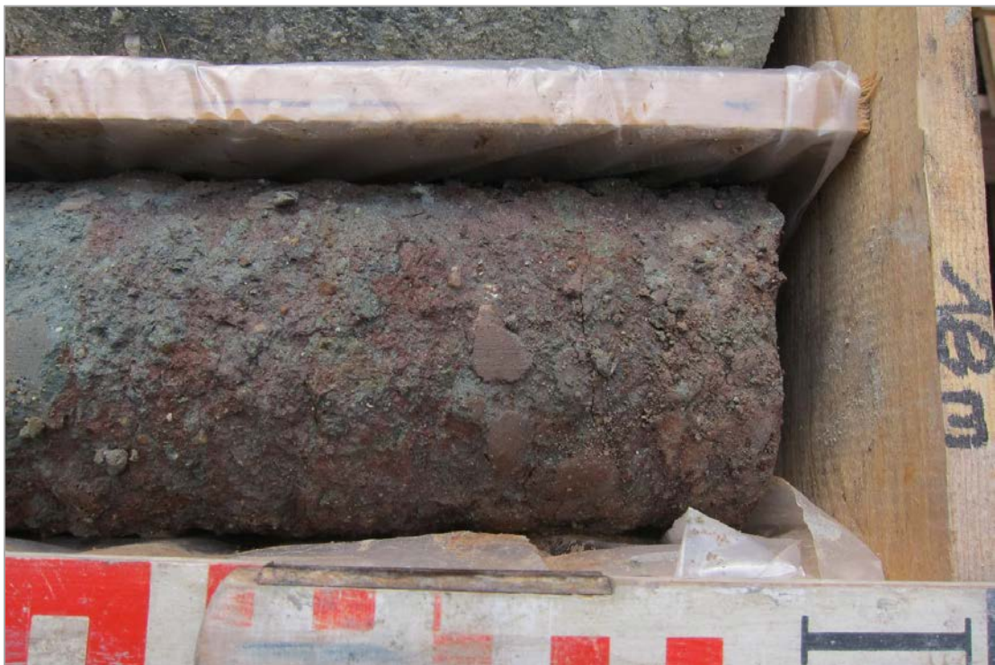
Abb. 2.1.2.28: Bohrung Gratz: 38,0 m – Grobsandige Linz-Melk-Formation mit „Kristallgefüge“ (Foto: M. Peresson).
