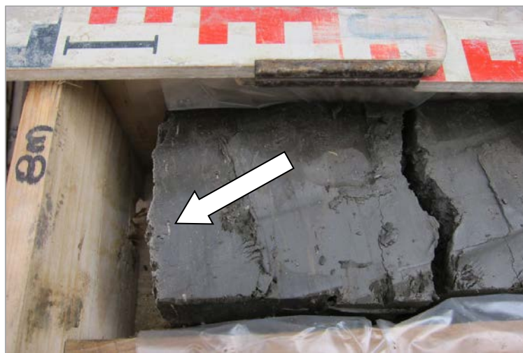
Abb. 2.1.2.9: Bohrung Niederthal: 14,0-18,0 m – Eferding-Formation mit deutlich ausgebildeter ebener Lamination (Foto: M. Peresson).
