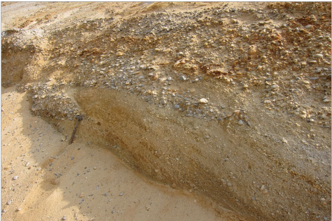
Abb. 2.1.1.12.: Bereich Unterflurtrasse Ganglsiedlung E-Wand – Schrägschichtungsets innerhalb der Kiesfazies des Freistädter Tertiärs (ÖK 33) (Foto: M. Peresson).
