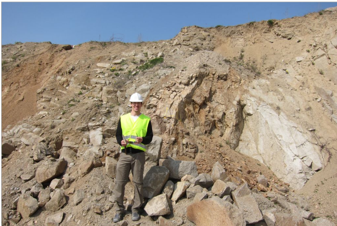
Abb. 2.1.1.39.: Bereich Freistadt Nord: Feinkörniger, stark verwitterter und geklüfteter Freistädter Granodiorit (Foto: M. Peresson).
