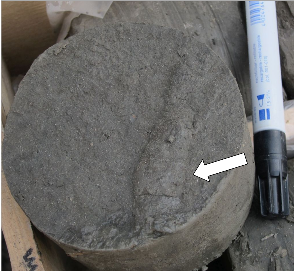
Abb. 2.1.2.11: Bohrung Niederthal: 25,0 m – Eferding-Formation mit Wühlgang und Hellglimmeranreicherung auf der Schichtfläche (Foto: M. Peresson).
