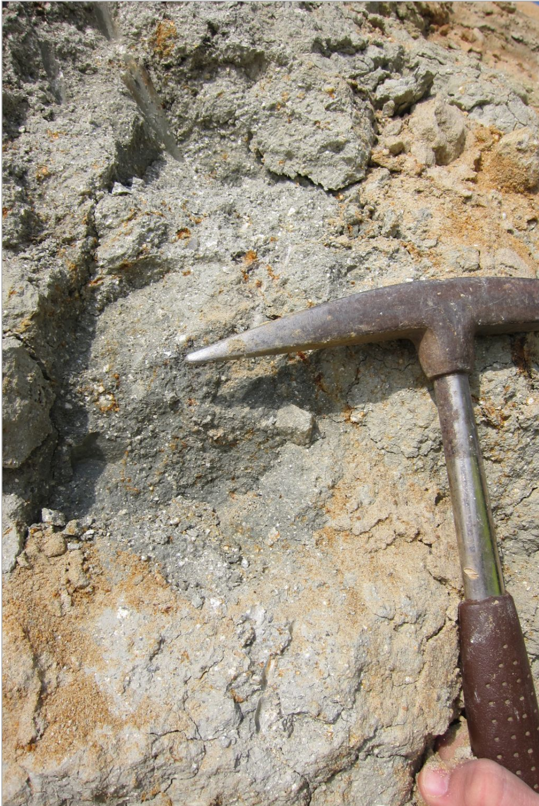
Abb. 2.1.1.31.: Bereich nördlich der Unterflurtrasse Ganglsiedlung, W-Wand: aufgearbeitete, eckige weiße Feldspatkomponenten innerhalb der Tonfazies im Freistädter Tertiär (Foto: M. Peresson).
