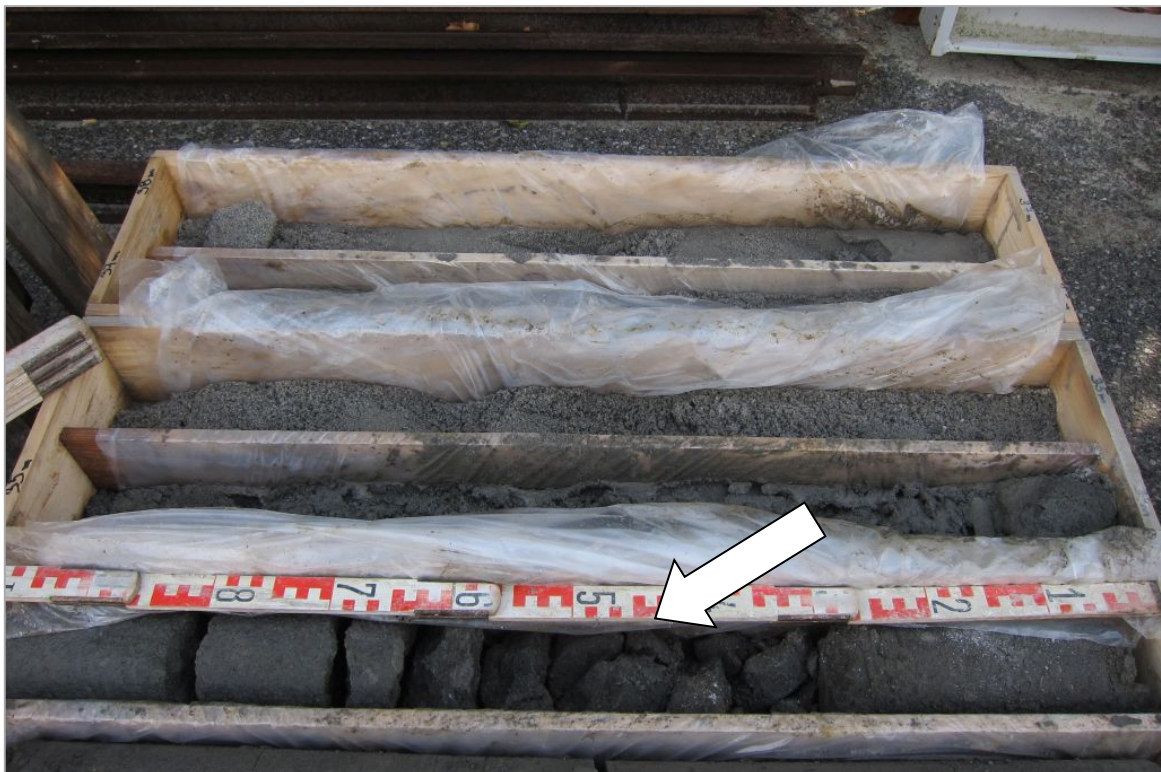
Abb. 2.1.2.14: Bohrung Niederthal: Übergang der schluffig, tonigen Eferding-Formation zur sandreichen Linz-Melk-Formation bei 33,5m (siehe Pfeil) (Foto: M. Peresson).
