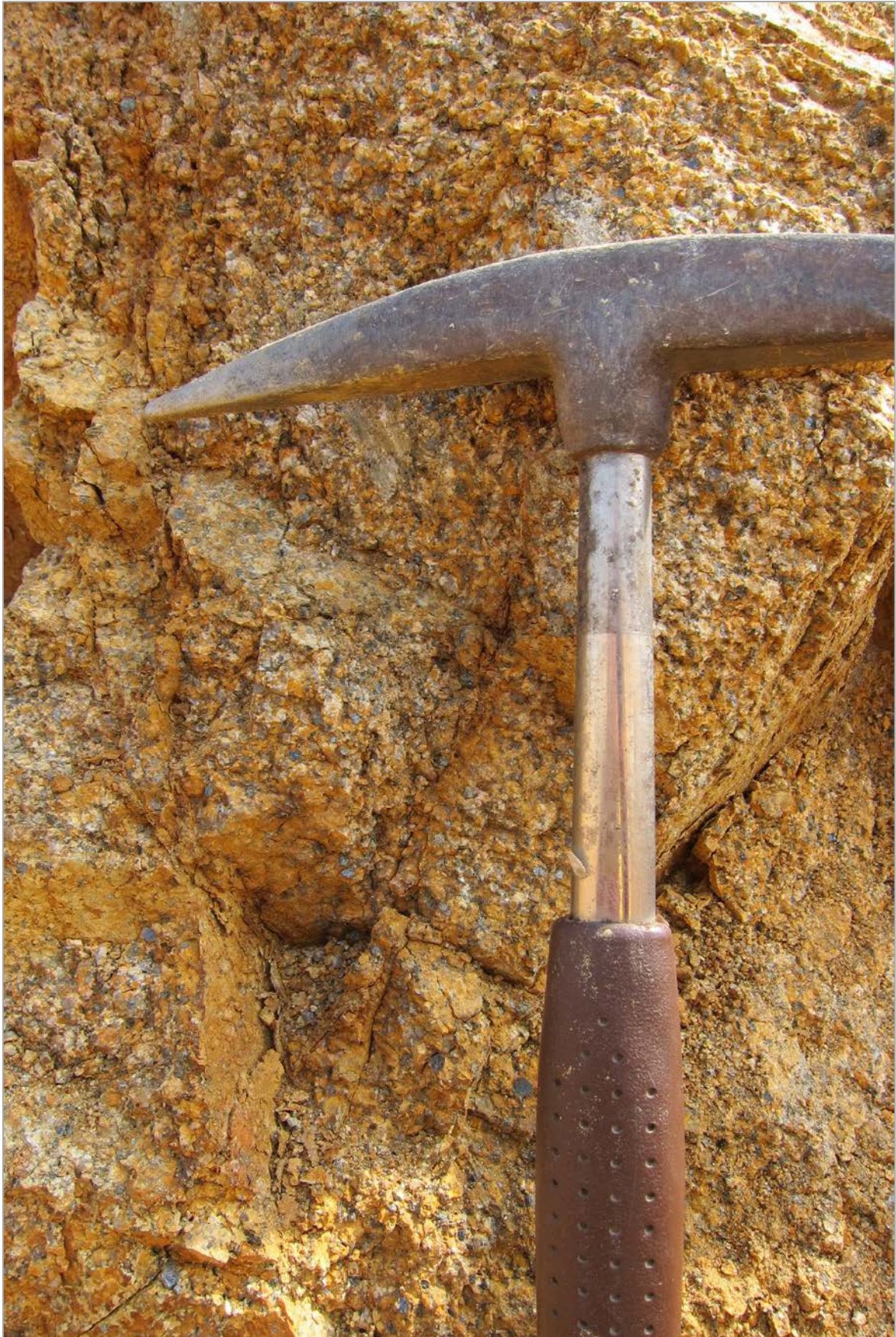
Abb. 2.1.1.24.: Nördlich Unterflurtrasse Gangsiedlung, E-Wand: Detailfoto des Freistädter Granodiorit mit schwarzen Biotiten, grauem Quarz und gelblichen Feldspäten (Foto: M. Peresson).
