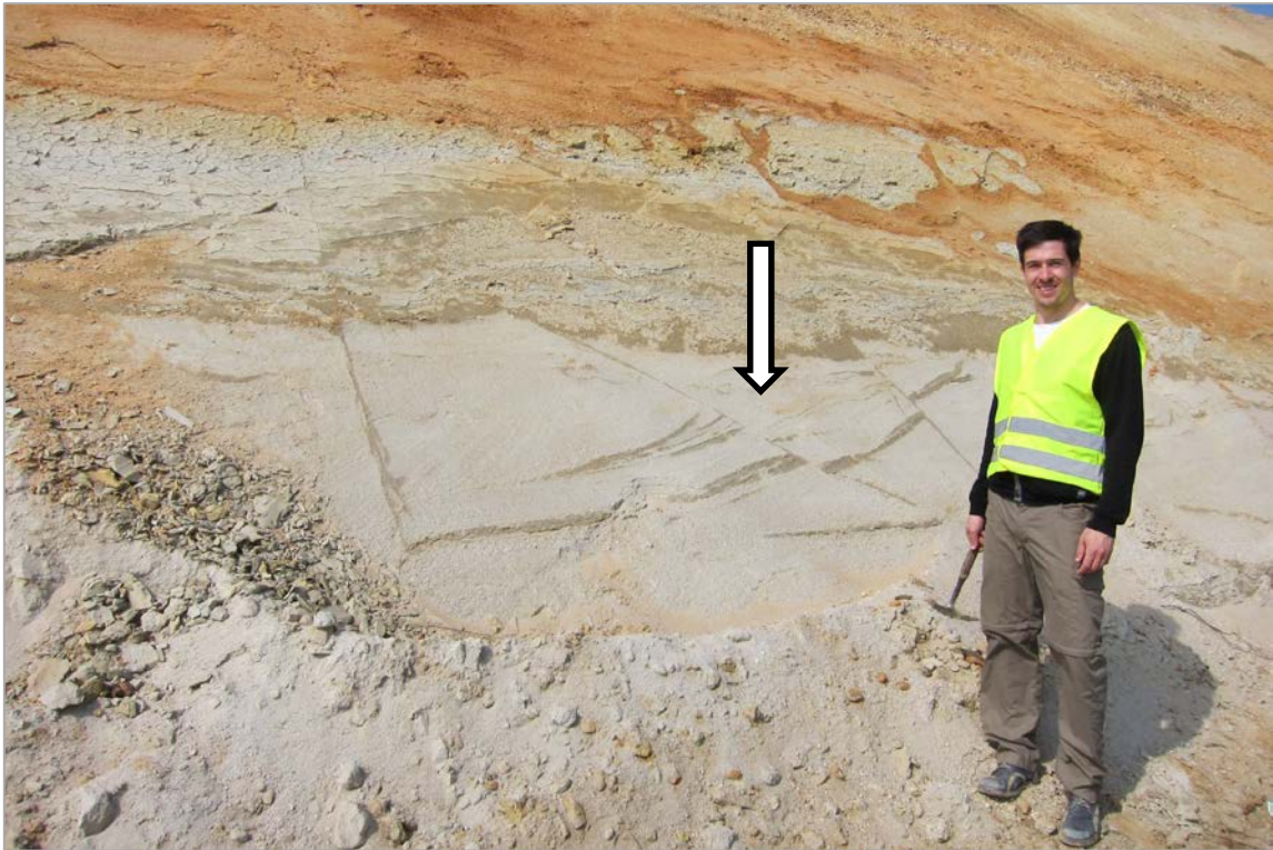
Abb. 2.1.1.27.: Bereich nördlich der Unterflurtrasse Ganglsiedlung, W-Wand: Sand- und Tonfazies mit Abschiebungsstrukturen (Pfeil) im Freistädter Tertiär (Foto: M. Peresson).
