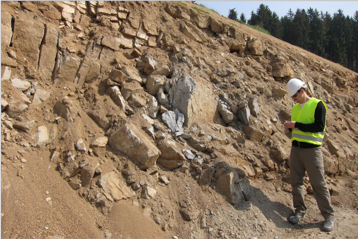
Abb. 2.1.1.38.: Bereich Freistadt Nord: Feinkörniger, stark verwitterter und geklüfteter Freistädter Granodiorit (Foto: M. Peresson).
