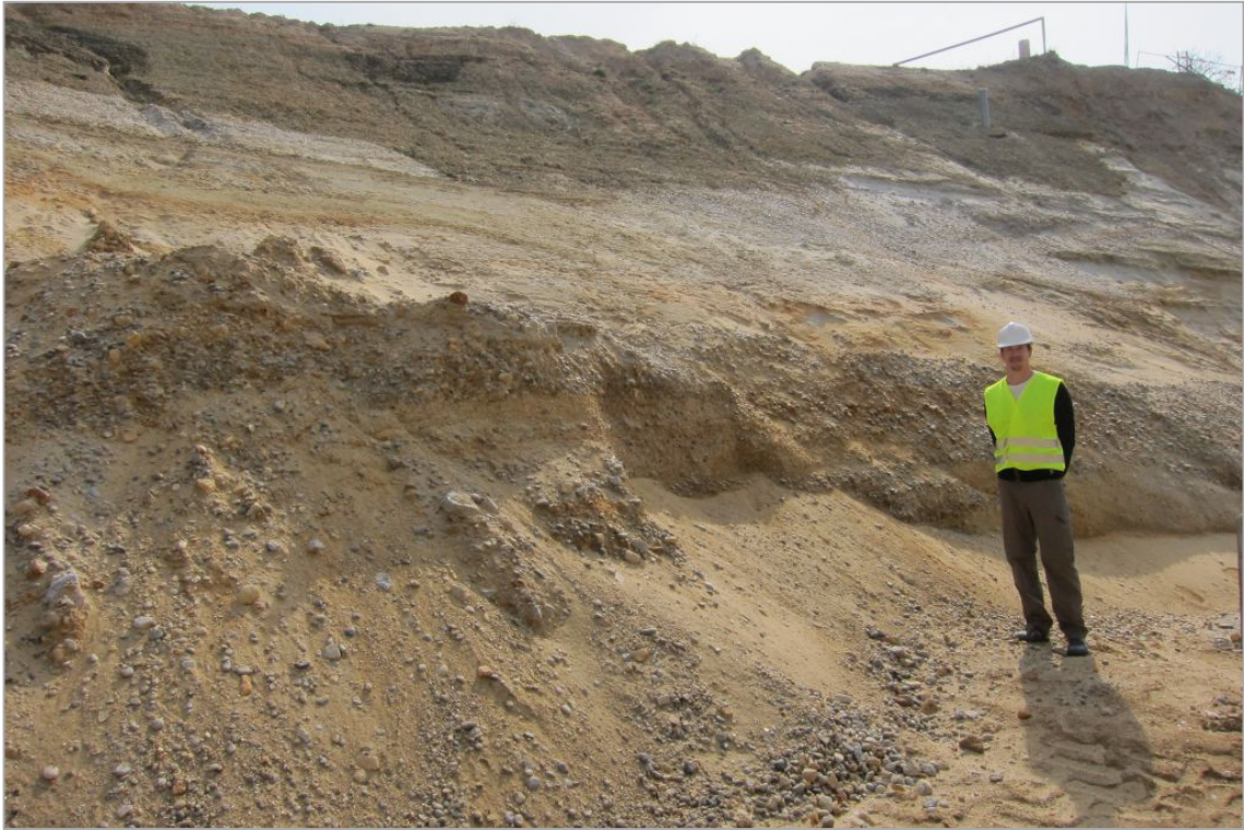
Abb. 2.1.1.11.: Bereich Unterflurtrasse Ganglsiedlung E-Wand – Kies- und Sandfazies des Freistädter Tertiärs (ÖK 33) (Foto: M. Peresson).
