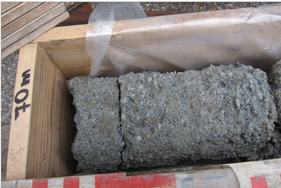
Abb. 2.1.2.16: Bohrung Niederthal: Kiesige Ausbildung der Linz-Melk-Formation bei 70,0 m mit Quarz reichem Komponentenspektrum (Foto: M. Peresson).
