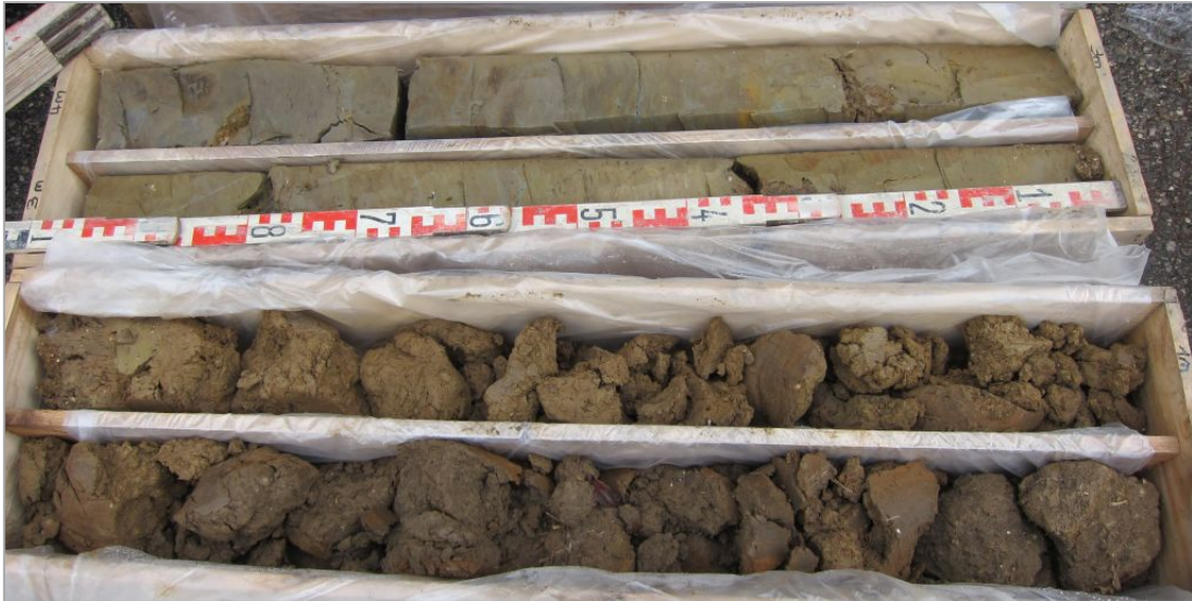
Abb. 2.1.2.7: Bohrung Niederthal: 0,0-3,3 m – Deckschichten (Foto: M. Peresson).
