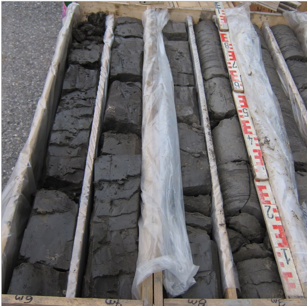
Abb. 2.1.2.8: Bohrung Niederthal: 5,0-10,0 m – Pelit dominierte Eferding-Formation (Foto: M. Peresson).
