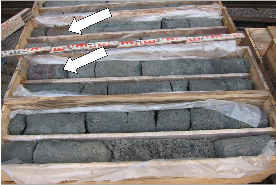
Abb. 2.1.2.17: Bohrung Niederthal: Sand dominierte Linz-Melk-Formation mit rötlich brauner pelitischer Einschaltung der Pielach-Formation (Foto: M. Peresson).
