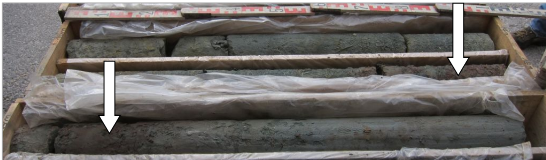
Abb. 2.1.2.23: Bohrung Gratz: 16,0-19,0 m – Einschaltung der Pielach-Formation (violett-rot) innerhalb der grauen sandig, schluffigen Linz-Melk-Formation (Foto: M. Peresson).
