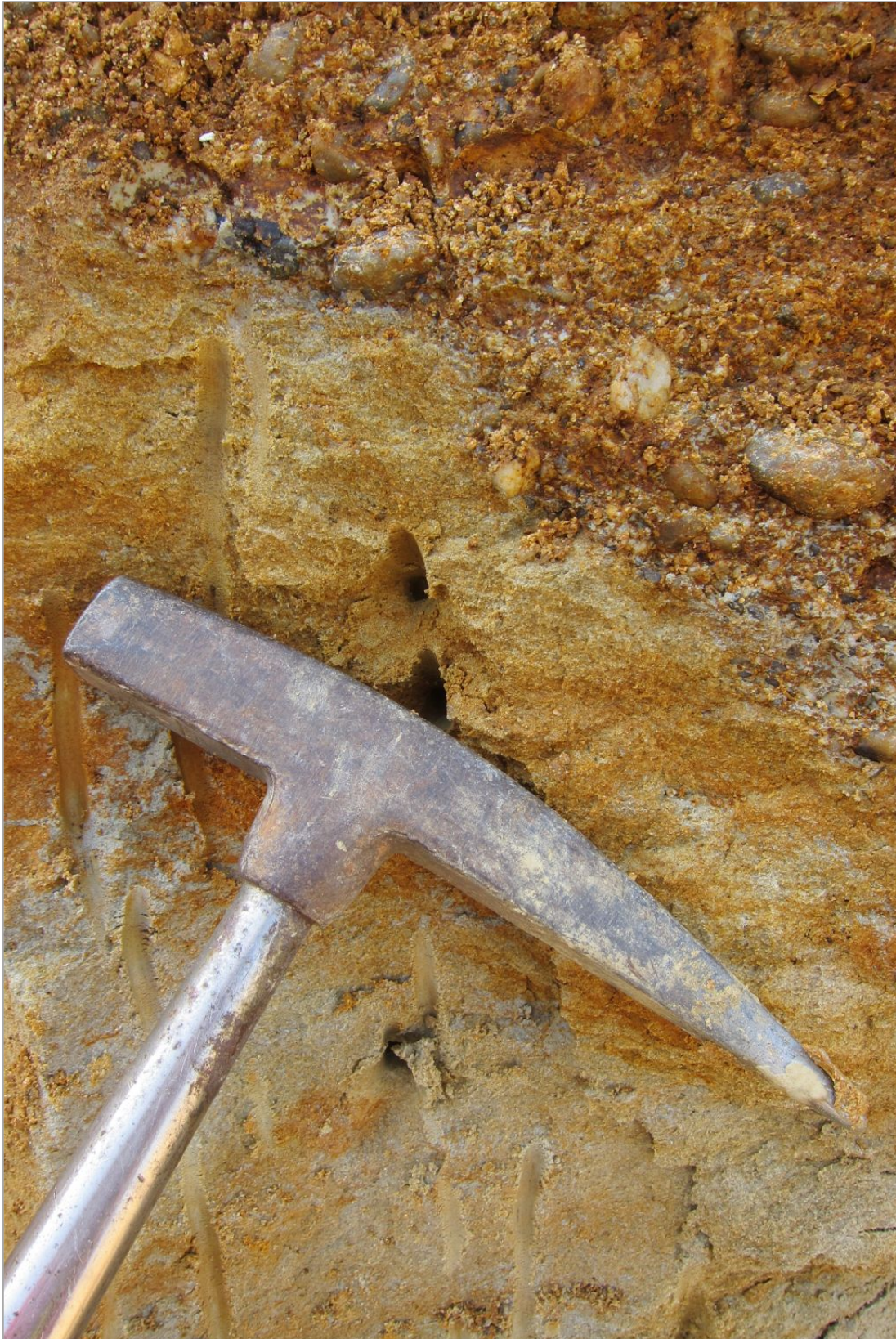
Abb. 2.1.1.19.: Bereich Unterflurtrasse Gangsiedlung E-Wand – scharfer Grenzbereich von gut gerundetem Kies (rötlich verwittert) zu grauem Schluff (Foto: M. Peresson).
