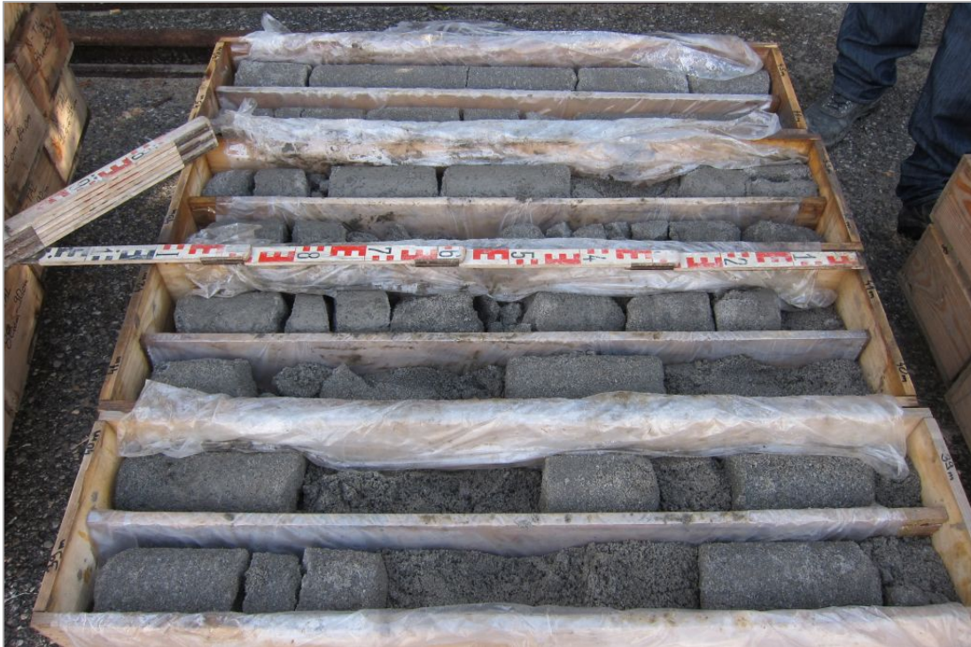
Abb. 2.1.2.15: Bohrung Niederthal: Sandige Linz-Melk-Formation zwischen 38,0-46,0 m (Foto: M. Peresson).
