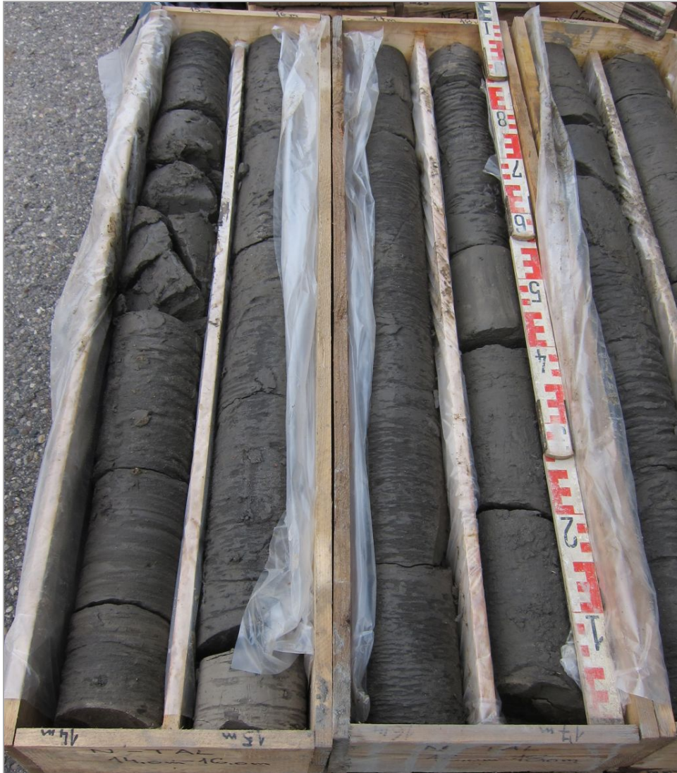
Abb. 2.1.2.9: Bohrung Niederthal: 14,0-18,0 m – Eferding-Formation mit deutlich ausgebildeter ebener Lamination (Foto: M. Peresson).
