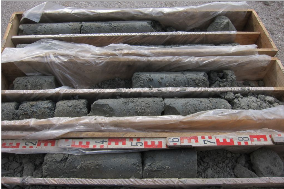
Abb. 2.1.2.24: Bohrung Gratz: 20,0-25,0 m – Wechsellagerung von Sanden und Schluffen in der Linz-Melk-Formation (Foto: M. Peresson).
