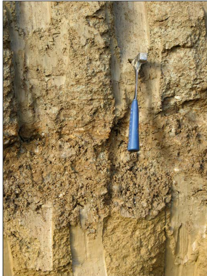
Abb. 2.3.1.8.: Baugrube Ottnang i. Hausruck: Detail der Kieslinse im Schluff; gut gerundete Quarz-Quarzitgerölle (Foto: Ch. Rupp).
