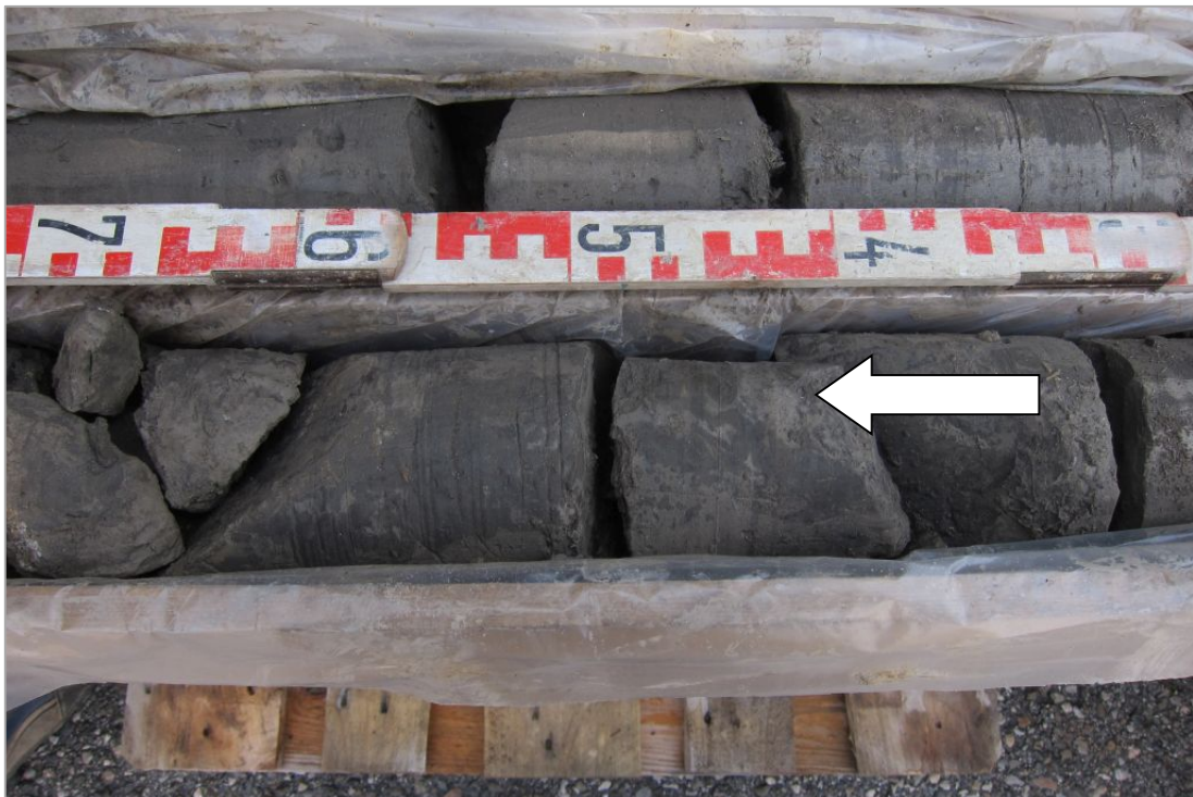
Abb. 2.1.2.11: Bohrung Niederthal: 25,0 m – Eferding-Formation mit Wühlgang und Hellglimmeranreicherung auf der Schichtfläche (Foto: M. Peresson).
