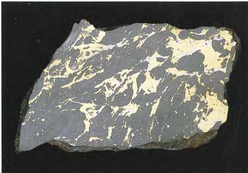
Abb. 16: Reicherz aus der Kupferlagerstätte Hochfeld. Das goldgelbe Erz besteht vorwiegend aus Chalkopyrit, Pyrit und Pyrrhotin. Das Trägergestein ist Biotit-Chloritschiefer. Objektbreite: ca. 15 cm. (Foto: A. Schumacher)
