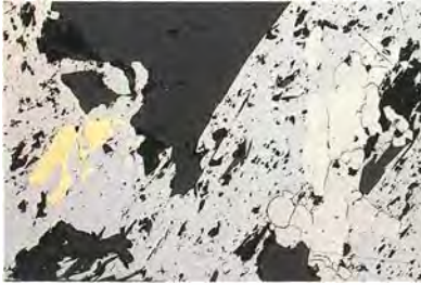
Abb. 8: Erzmikroskopische Aufnahme: Gediegen Gold, Tetradymit (weiß), Cobaltit (rosa, xenomorphe Körner) in Cosalit-Galenit-Matrix. Christoph-Revier, Radhausberg. Erzanschliff. Bildbreite: ca. 1,5 mm. (Foto: W. H. Paar)
