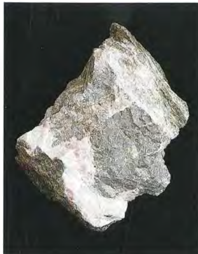
Abb. 22: Scheelit-Derberz aus dem Wolframbergbau Mittersill. Untertagebau Westfeld. Der Scheelit ist infolge feiner Einschlüsse von Molybdänit-Tungstenit grau gefärbt. Daneben Beryll (blau) und Fluorit (hellviolett) in Quarzgang. Handstück. (Foto: A. Schumacher)
