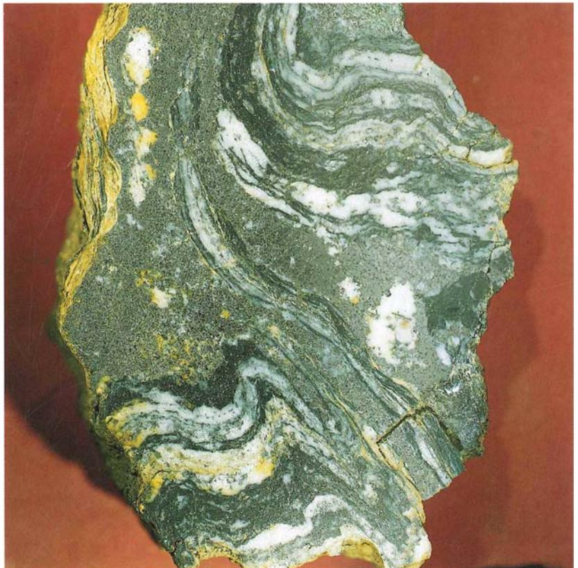
Abb. 20: Gold- und silberführendes *Sphalerit-Galenit*-Erz in stark verfalteten graphitführenden Quarziten. Sprinzgasse, Oberes Murtal. (Foto: J. Burgstaller)
