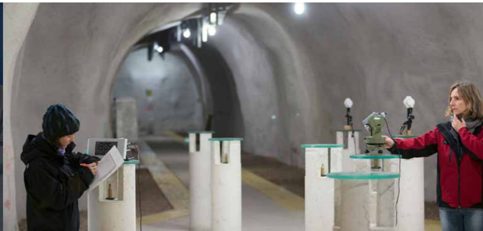
Absolutmessung von Richtung und Stärke des aktuellen Erdmagnetfeldes Absolute measurement of the current direction and strength of the earth's magnetic field
