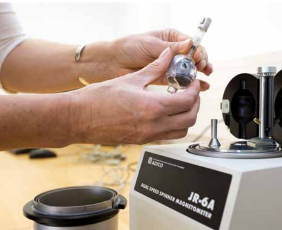
Messung der Magnetisierung von Gesteinsproben Measuring the magnetisation of rock samples
