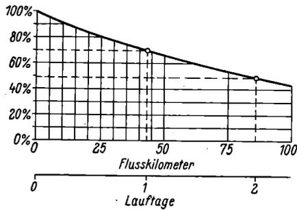
Bild 2. Selbstreinigungskurve für eine Fließgeschwindigkeit von 0,5 m/s und für eine tägliche Abnahme des Sauerstoffbedarfs um 30 v.H.
