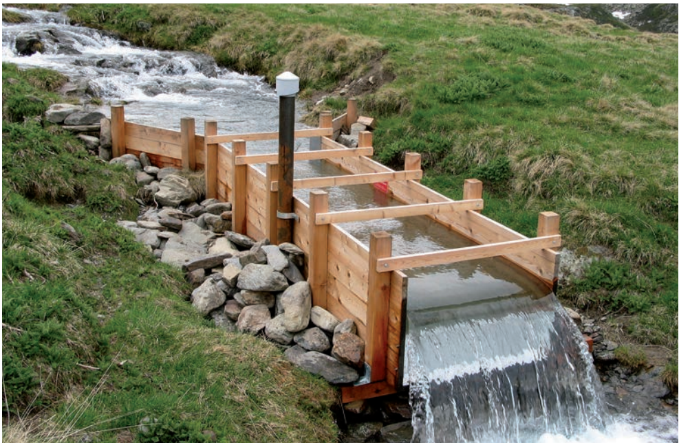
Abb. 12: Pegelmessstelle des hydrographischen Dienstes zur Messung des Gesamtabflusses des Blockgletschers im Äußeren Hochebenkar
