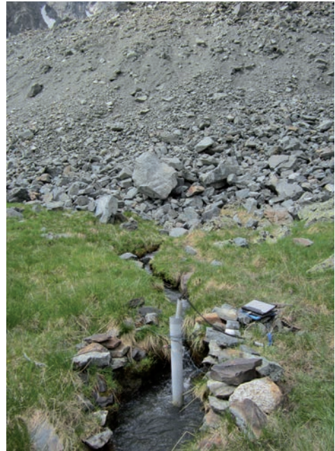
Abb. 6: Pegelmessstelle am Blockgletscherbach vor der steilen Stirn des aktiven Blockgletschers im Inneren Reichenkar (westliche Stubai Alpen)
