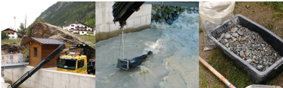
Abb. 20: Geschiebemessung mit einem mobilen Geschiebefänger (a, b) und die erschotete Geschiebeprobe (c) am Pegel Vent/Rofenache (Fotos: Hugo Seitz, Institut für Wasserwirtschaft, Hydrologie und Konstruktiven Wasserbau, IWHW, an der BOKU/Wien)
