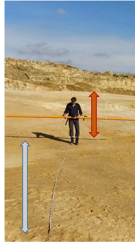
Abb. 26: EM-CMD-Explorer Messung entlang Geoelektrik- profil Karl P01, Blickrichtung gegen Osten, roter Blockpfeil kennzeichnet noch abzubauenen Quarzsand, grauer Blockpfeil kennzeichnet den bereits ausgesandeten Bereich
