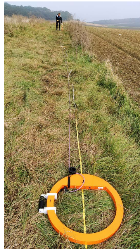
Abb. 30: EM-CMD-DUO Messung entlang Goelektrikprofil Karl P2a, Blickrichtung gegen Osten
