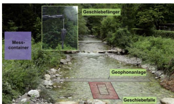
Abb. 70: Johnsbach – schematische Darstellung der Geschiebetransportmessstelle Johnsbach
