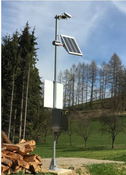
Abb. 76: Brunnstubenbach – IP-Kamera, Solarmodul und Datenübertragungsbox
