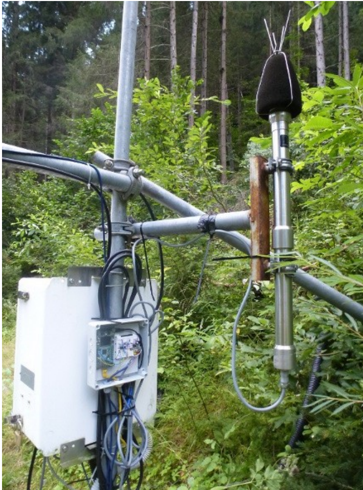
Abb. 52: Lattenbach – Infrasonsensord und Datenbox
