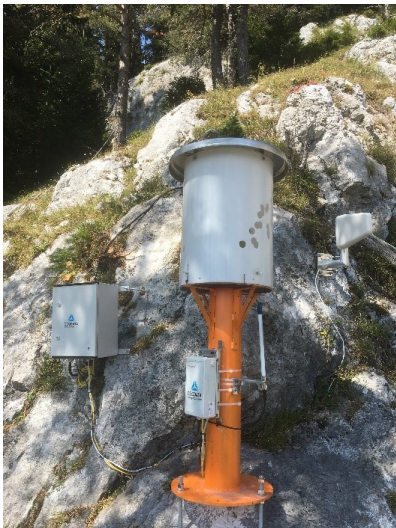
Abb. 42: Pürggerwand - vollautomatische Totalstation mit Abdeckung
