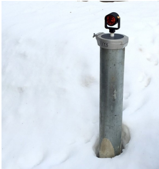
Abb. 25: Kerschbaumsiedlung – Reflektorprisma für den Autotheodolit
