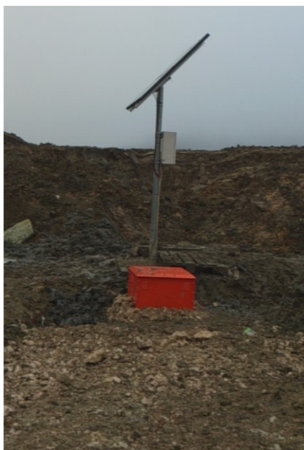
Abb. 46: Pechgraben – Datenbox mit Solarmodul für Inklinometermessungen
