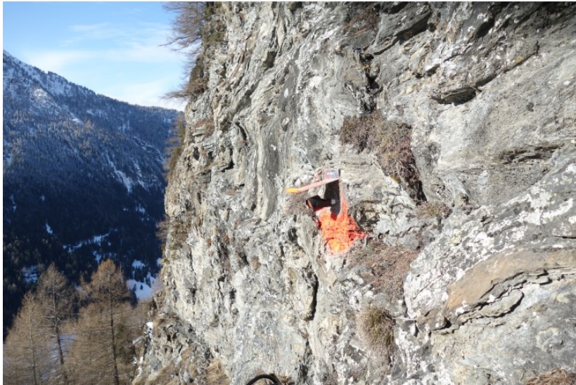
Abb. 31: Vals – Prismenreflektor an der Felswand
