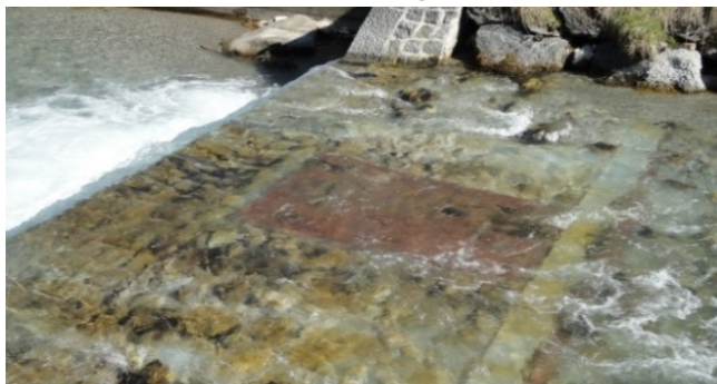
Abb. 69: Urslau – Detailfoto der Geophonanlage und Geschiebefalle
