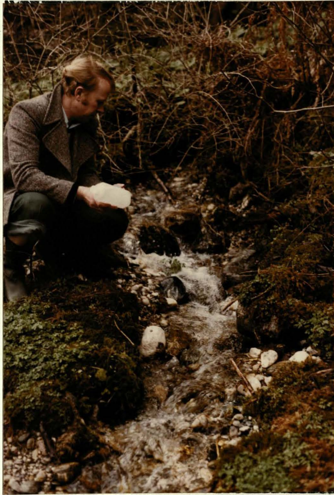
Bild 8 : Die Messung der Wassertemperatur und Entnahme einer Probe direkt am Ursprung einer Quelle.
