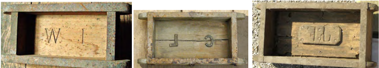
Abb. 9. Diverse Model: Buchstaben eingeschnitzt, einzelne Lettern aus Leder, Platte aus Holz.
