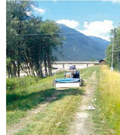
Das motorisierte Georadar ermöglicht detaillierte Analysen der Dämme entlang der Gail in Kärnten.
