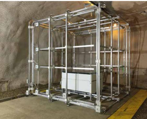
Testbereich für hochsensible Magnetfeld-Messgeräte
