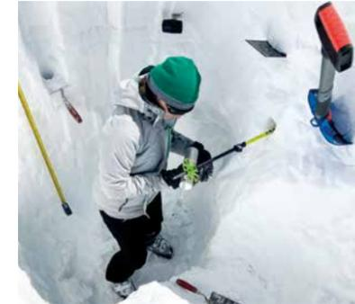
Ermittlung der Schneedichte zur Berechnung der Massenbilanz des Gletschers.
