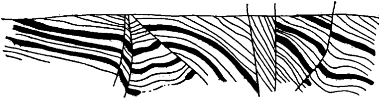
Fig. 1. Schichtenstörungen in den Schiefeln und Quarziten der nördl. Zone d_5 an der Pilsener Hauptstrecke. Etwa 1:1000.
