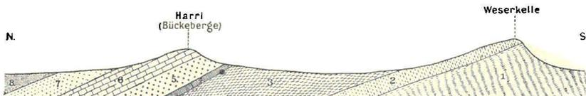
Abb. 111. Profil durch zwei Erosionskammgebirge. Bückeberge und Weserkette. 1 mittlerer, 2—5 oberer Jura, 6—8 untere Kreide. Die Schichten 2 (Kalk) und 6 (Sandstein) sind widerstandsfähiger als die anderen. Nach STILLE.
