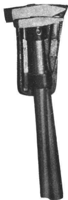
Fig. 19. Hämmer für petrographische Zwecke.
