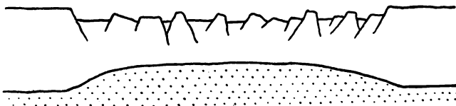
Größerer Einbruch durch Dehnung der Unterlage (schematisch).
