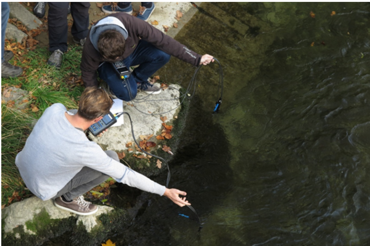
Messung allgemein physikalisch-chemischer Parameter an der Fuschler Ache (Salzkammergut)
