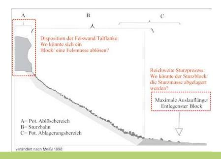
Sturzprozess in einem Rechengang simulieren kann. Die meisten der Modelle berücksichtigen lediglich die Position des Ablösebereichs und die Kubatur/Form des Sturzblockes/-masse.
