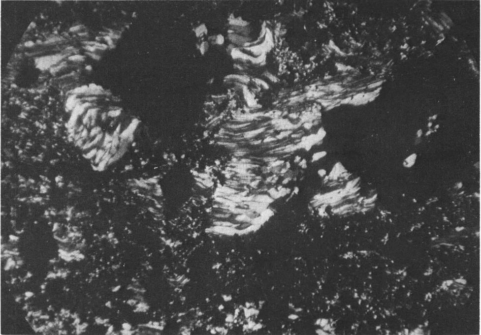
Abb. 6. Verworrenes, parallelstrahlige bis rosettenförmige Entwicklung der Quarzkristalle um große Anhäufungen von Erz. Dünnschliffphoto, Vergr.  $8 \times 8 + N$  (Brskovo).
