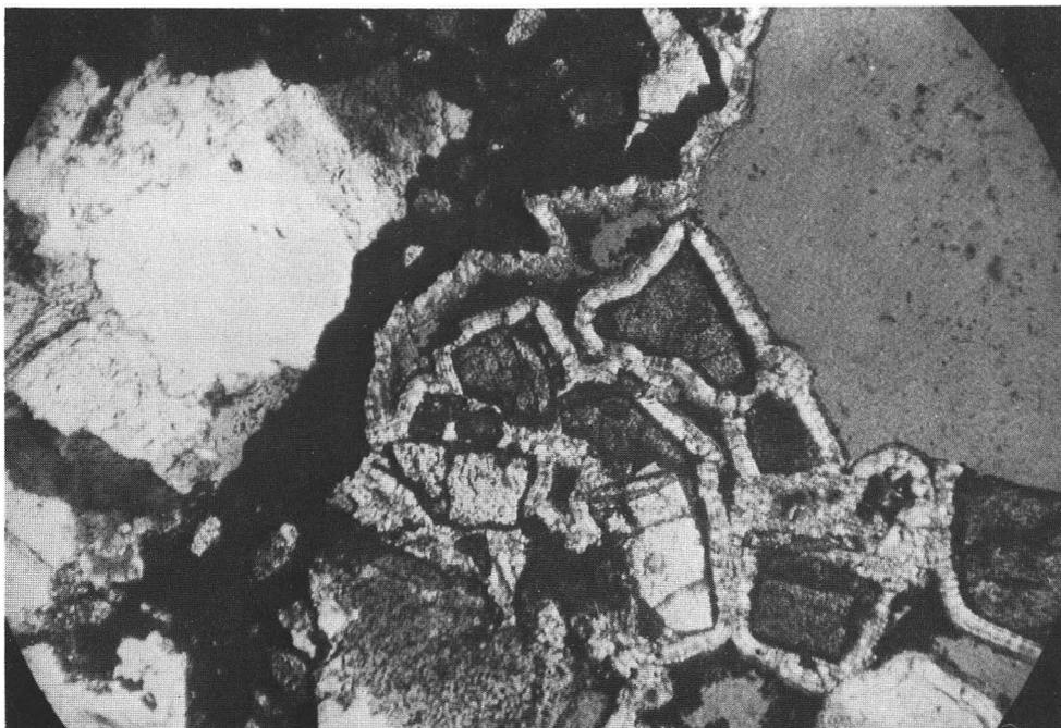
Abb. 5. Chalcedon umrahmt Epidotkristalle, links frische, rechts alte Quarzkristalle, Mitte Erzgang. Dünnschliffphoto, Vergr. 8×8+N (Lakonia).
