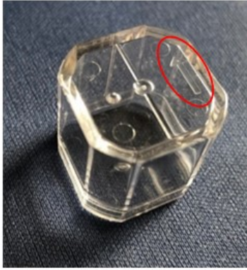
Abbildung 15 Nicht magnetischer Würfel für Materialgewinnung Probennahme (Seite des Würfels 1.5 cm ) mit Orientierungspfeile (rote Ellipse), um orientierte Proben im Gelände zu sammeln.
