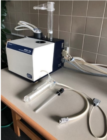
Abbildung 23 MTK1-FA Gerät. Im Vordergrund Thermometer und Kryostat noch nicht eingebaut. Der Ofen für die magnetische Thermoanalyse ist direkt in der oberen Fläche des Geräts sichtbar. Foto:Venturi
