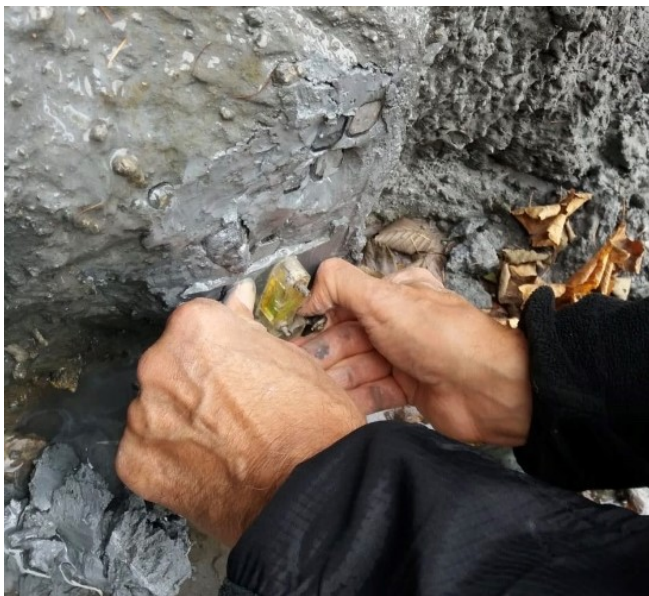
Abbildung 16 Gewinnung der orientierten Proben des Aufschlusses n.5 mit Hilfe einer kleinen Wasserwaage in der Störungszone der Kienzingbach Graben.
