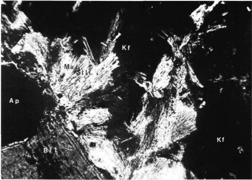
Abb. 6: Biotit I umgeben von spärrolitischem Sillimanit (hell, pseudomorph durch Muskowit ersetzt), der mit Kalifeldspat (dunkel) aus der Schmelze kristallisiert (Nicols +).
