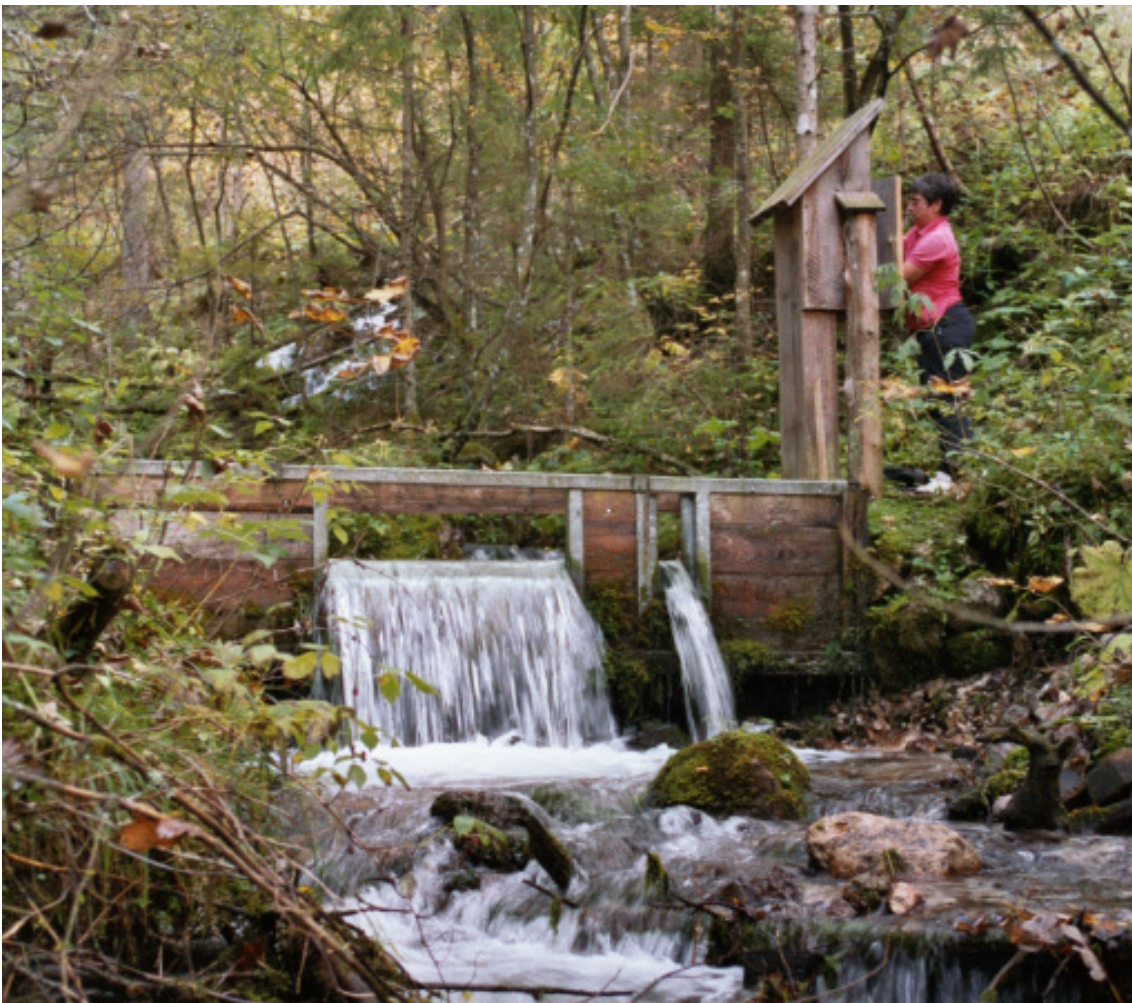
Abbildung 2: Messwehr Schwabeltalquelle (Steiermark)
