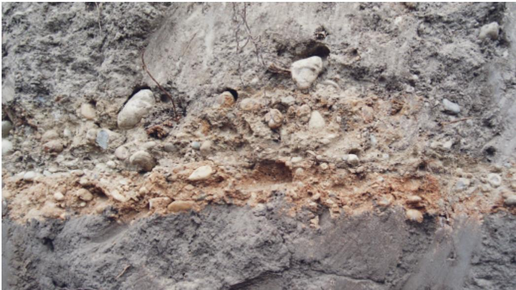
Abbildung 31: Bodenaufbau bei Obersiebenbrunn, Marchfeld, Niederösterreich
