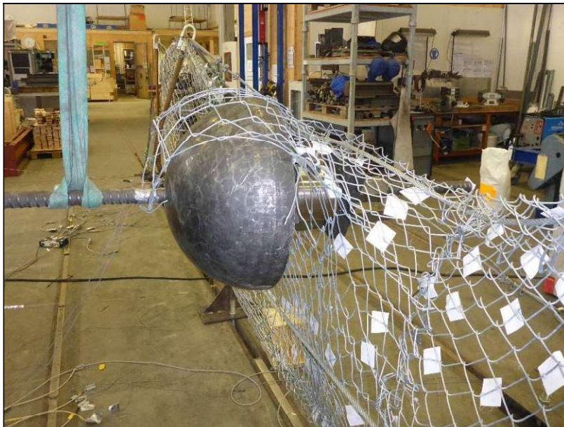
Abb. 5: Belasteter Zaun aus dem Laborversuch
