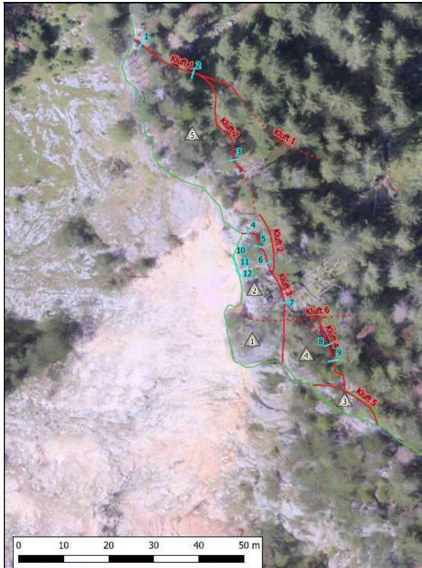
Abb. 6: Lage der Fissurometer 1 - 9 oberhalb der Pürggerwand im Bereich der Zerklüfte.
