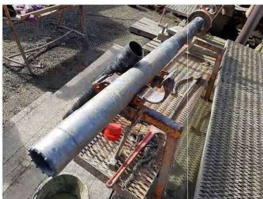
Doppelkernrohr mit PE-Inliner DN100
