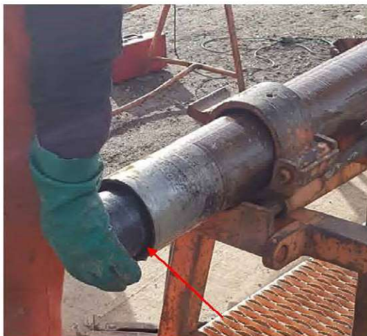
Doppelkernrohr mit PE-Inliner DN100
