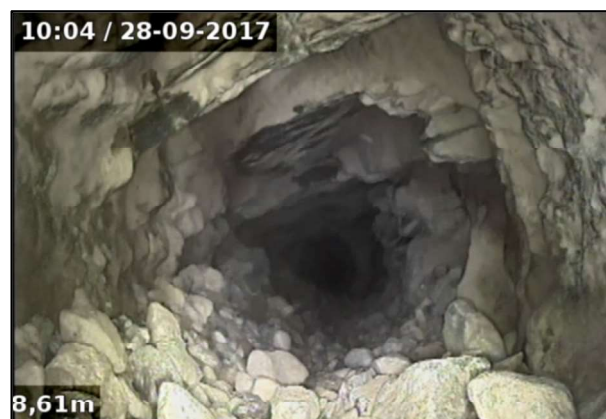
Abb. 4: Bohrlochkammerabefahrung in einer Erkundungsbohrung (links: intaktes Gebirge; rechts: zerlegter Bereich)
