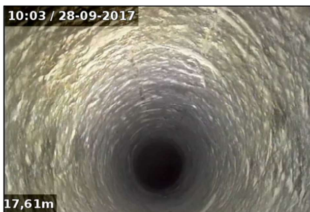
Abb. 4: Bohrlochkammerabefahrung in einer Erkundungsbohrung (links: intaktes Gebirge; rechts: zerlegter Bereich)
