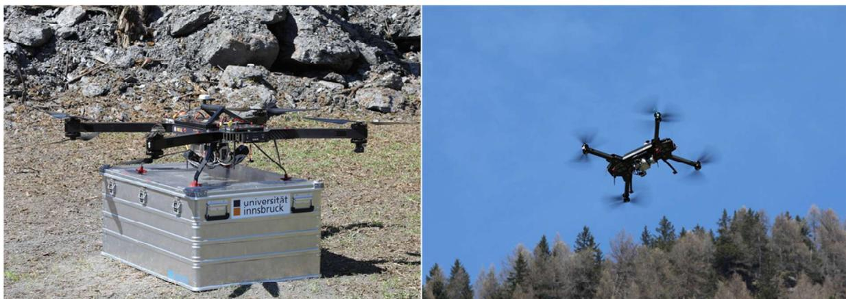
**Abbildung 5:** UAV Laserscanning System, Foto: Thomas Zieher (UIBK).
