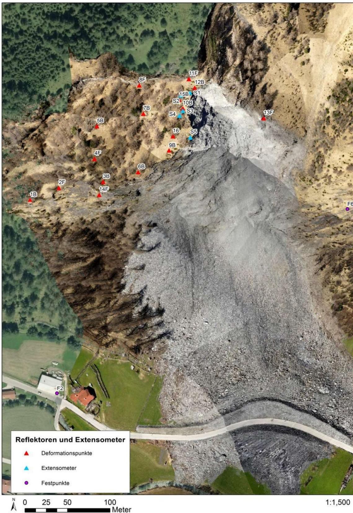
Abbildung 9: Lageübersicht der installierten Reflektoren (rot) und Extensometer (blau)
