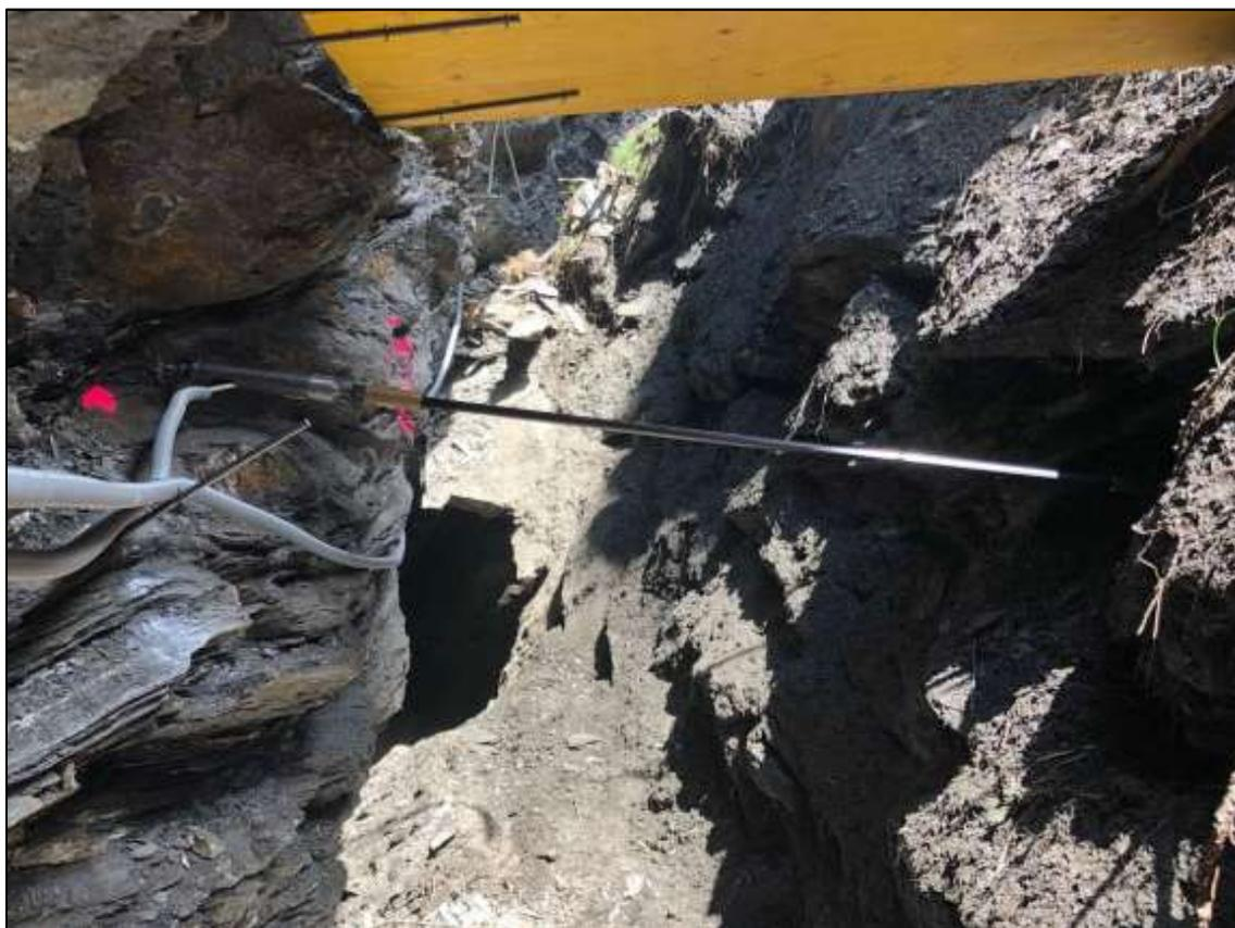
**Abbildung 8:** eingebauter Extensometer S3
