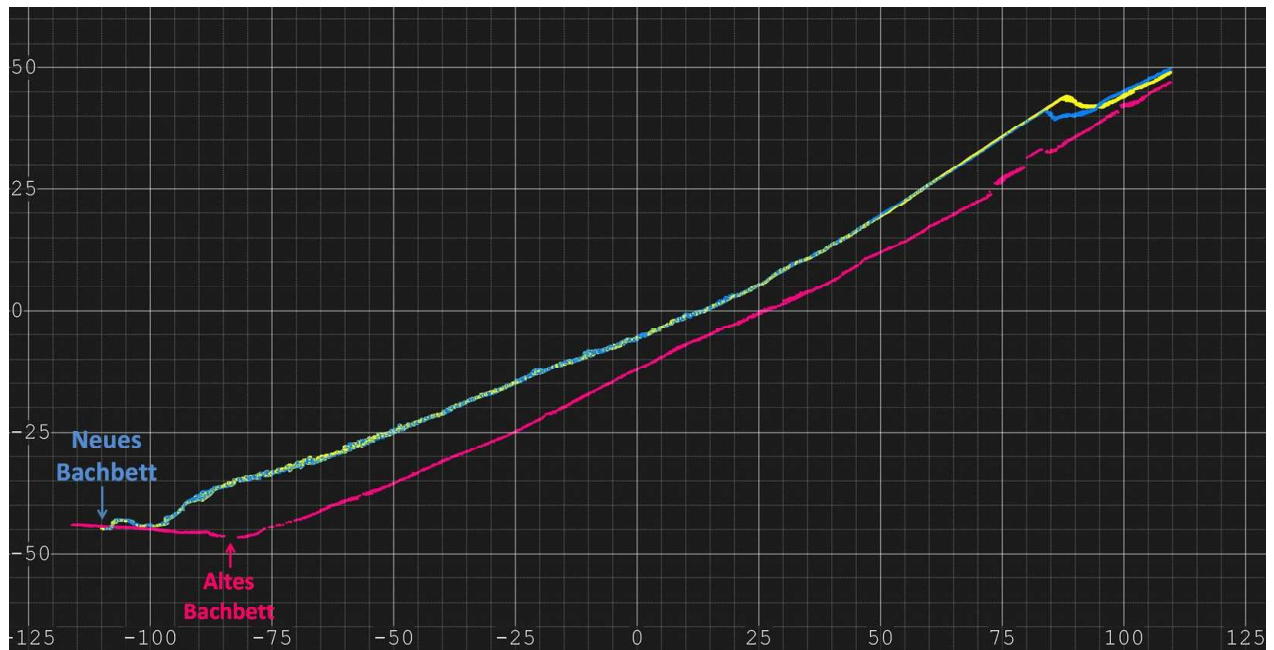
Abb. 10: Profilansicht des Schuttkegels (Querschnitt durch 3D-Punktwolke mit 1m Breite). Pink = Stand 2010 (vor Sturzereignis), gelb = Stand 2016, blau = Stand 2017. Einheit in Meter.
