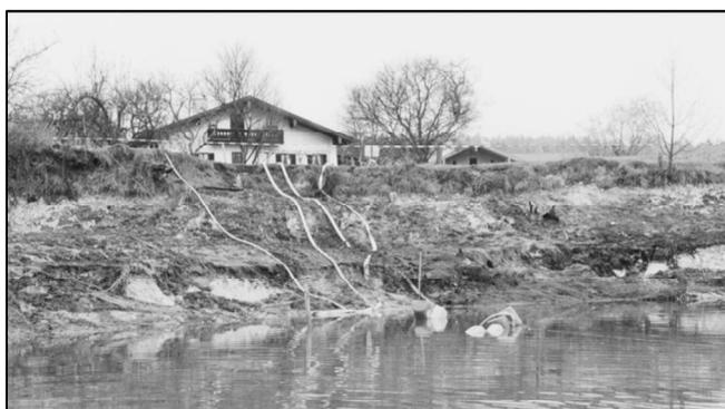
**Abb. 7:** Grögern Weiher beim Pumpversuch um 3,6 m abgesenkt (02.11.99)
