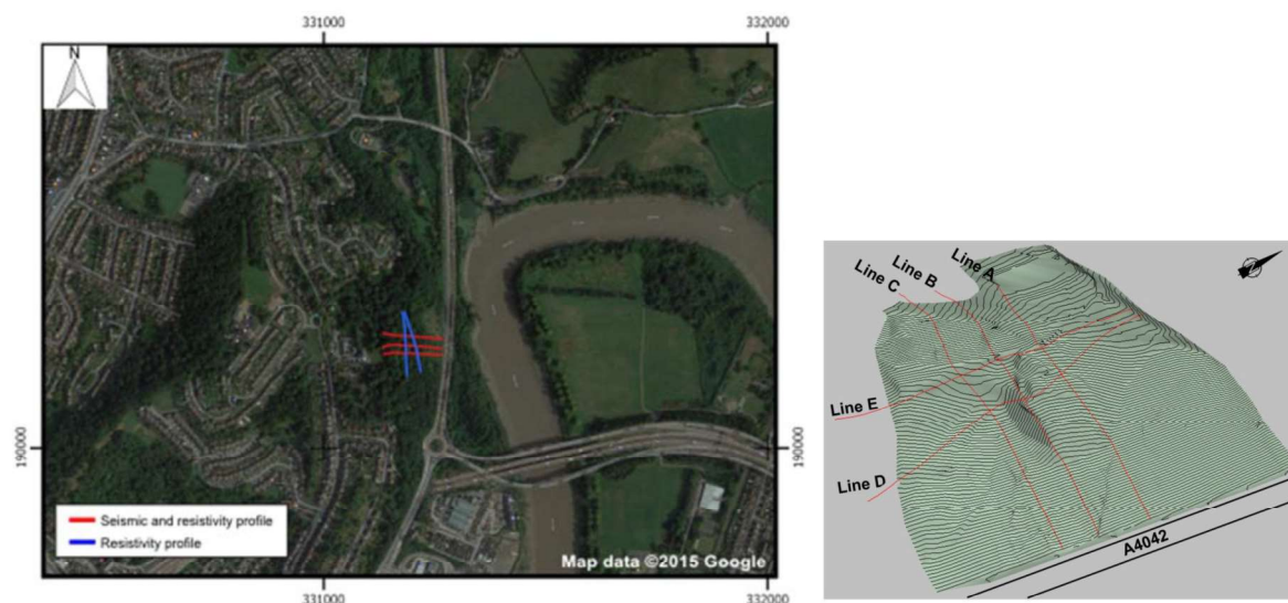
Abbildung 5: Links – Lage des Gebietes, Untersuchungsprofile in rot und blau (Satellitenbild Google, 2017). Rechts – DTM des untersuchten Gebietes.
