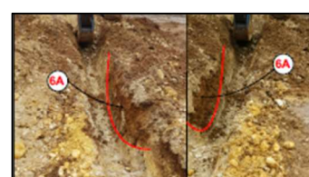
Abbildung 4: Beispiele von GPR Profilen gesammelt während eines Projektes zur Lokalisierung von bodennahen Karst in Kreide mit besonderen Boden-anomalien in rot/blau. Nach Auswertung der geophysikalischen GPR Daten wurden Anomalien am Boden gezielt freigelegt (rechts in Bildern).
