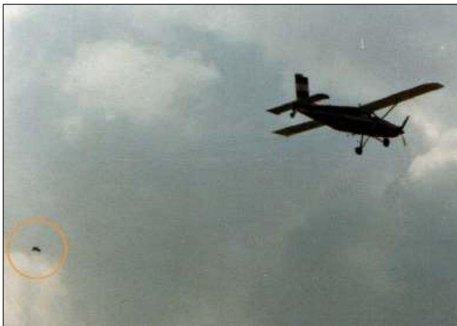
**Abb.3:** Pilatus Porter mit Protonen-Magnetometer Sensor im Schlepptau
