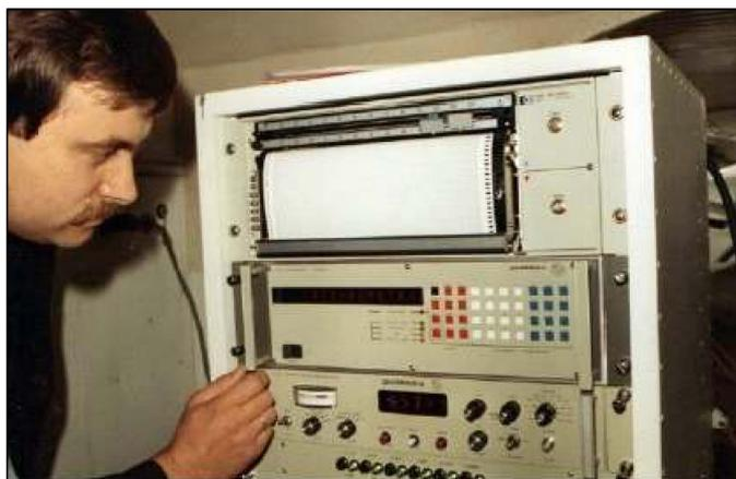
**Abb.4:** Protonen-Magnetometer mit digitaler und analoger Datenerfassungseinheit mit Peter Melichar im Pilatus Porter des BEV - Bundesamt für Eich und Vermessungswesen
