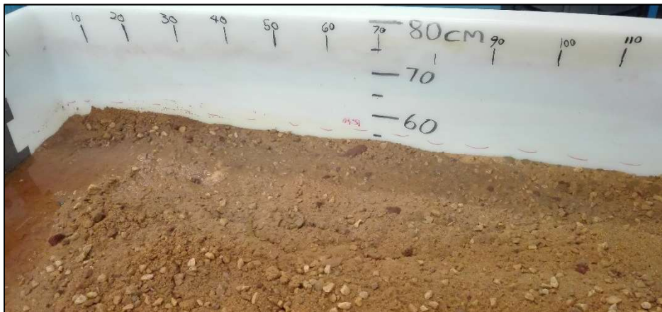
Abb. 2: Ausgebildete, laterale Randmulde mit beginnender „See“- und Rissbildung. Zulauf von Links in 30 cm Tiefe. Abstand der Markierungsstriche 10 cm; rote, gestrichelte Line gibt die ursprüngliche Sedimenthöhe an (Foto: Wolkersdorfer).
