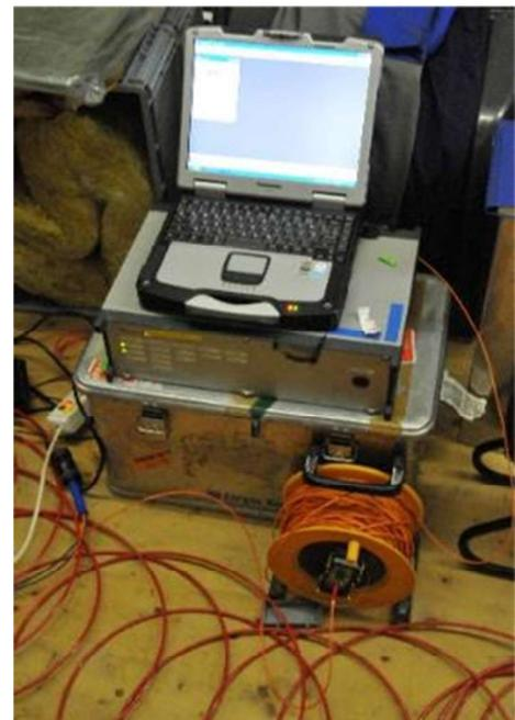
**Abb. 5:** Messaufbau EGRT
