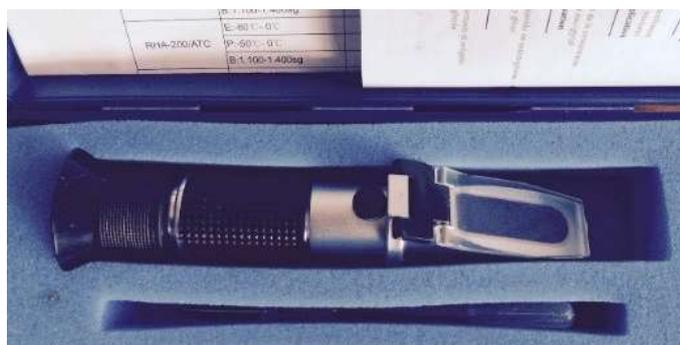
**Abb. 6:** Refraktometer zur Bestimmung des Frostschutzgehaltes der Sole.
