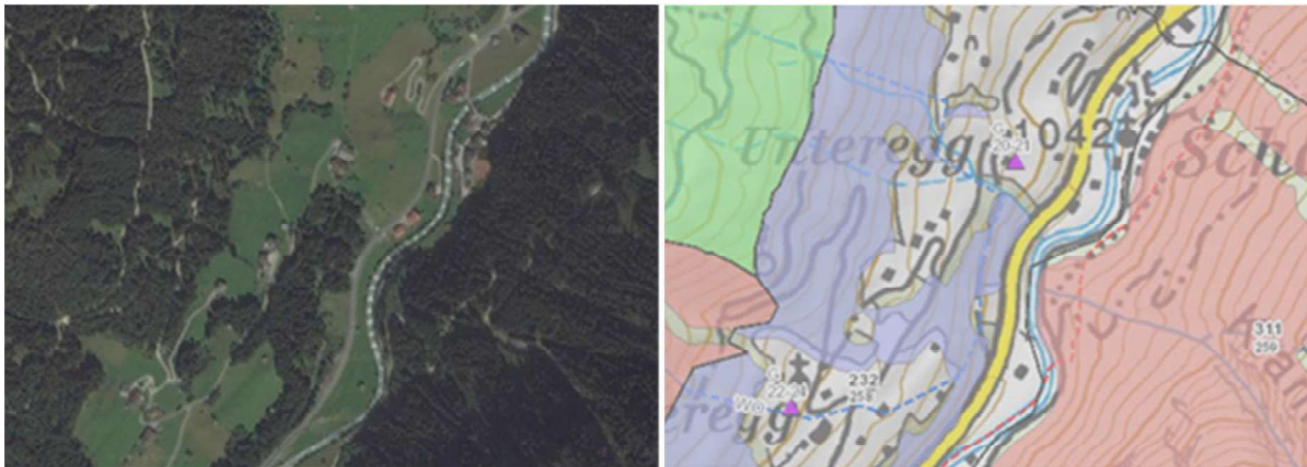
Abb. 1: Vergleichender Kartenausschnitt: Links die Waldbedeckung, rechts die generalisierte Darstellung der Funktionen im WEP (Rot: Schutzfunktion).
