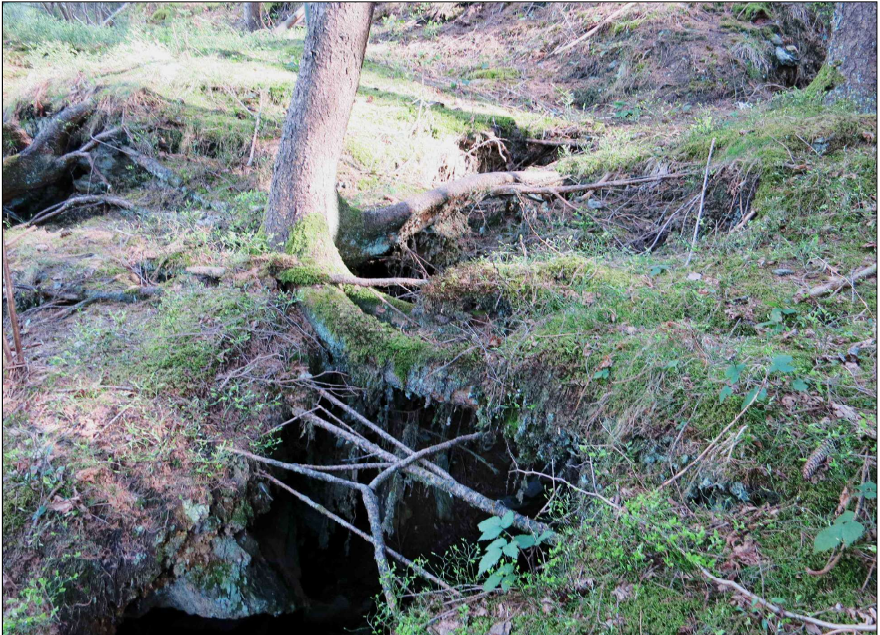
Abb. 6: Offene Spalten mit gespannten Wurzeln im zentralen Bereich der Massenbewegung
