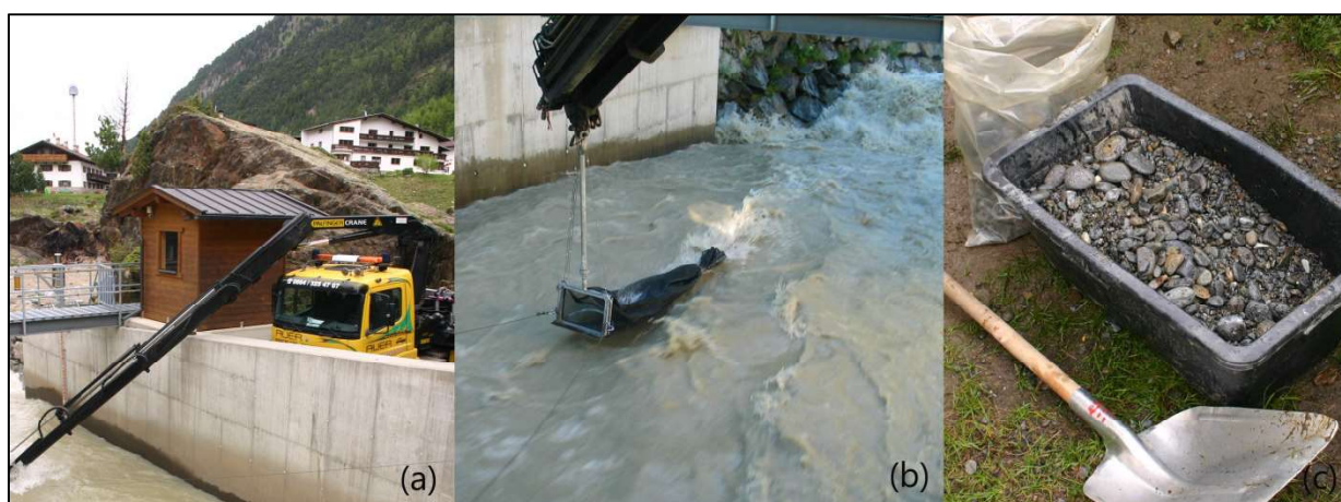
Abb. 14: Geschiebemessung mit dem mobilen Geschiebefänger (a,b), Geschiebeprobe (c)
