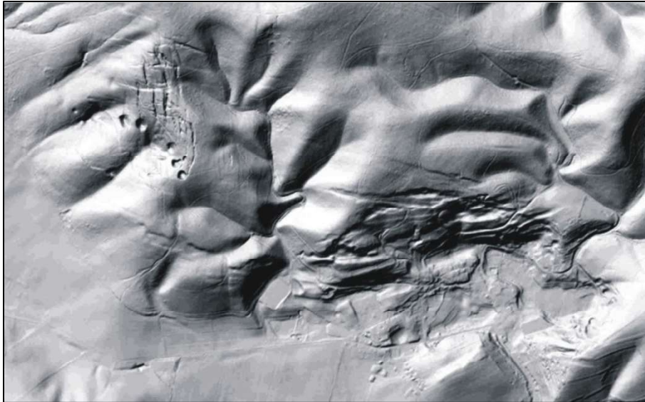
Abb. 7: Darstellung des digitalen Geländemodells als Schummerungskarte für die Region um die Ortschaft Frauensee. Deutlich sind die für einen „Salzhang“ charakteristischen Zerrspalten und Erdfalle zu erkennen.
