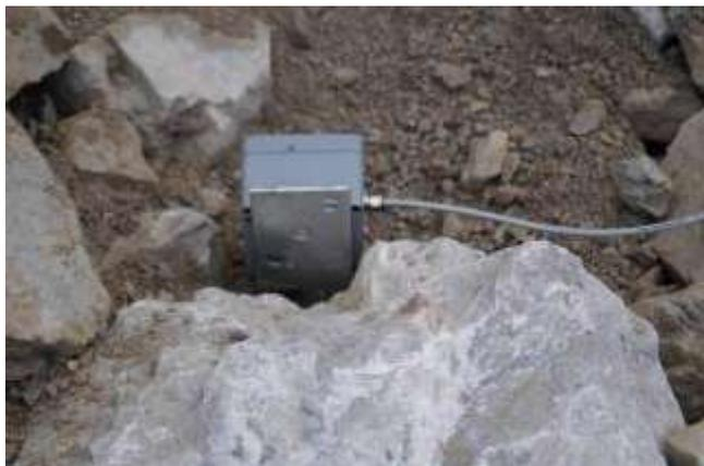
**Abb. 8:** Elektro-Mechanischer Wandler
