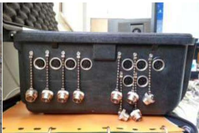
**Abb. 7:** Wasserdichte Sensorenschnittstellen
