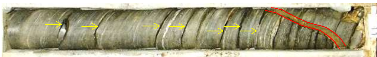
Abbildung 19: hydraulisch gering wirksame Schieferungsflächen (gelbe Pfeile) und „offene“ hydraulisch wirksame Klüfte (rot)
