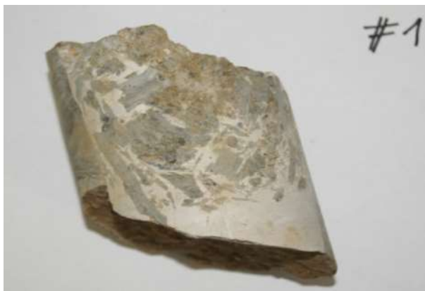
Abbildung 21: Injizierte, steilstehende Kluft
