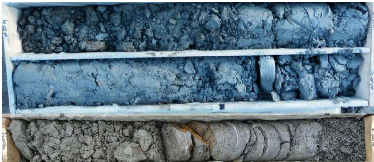
Abbildung 20: Scherzone im orographisch linken Kernwandinbindebereich
