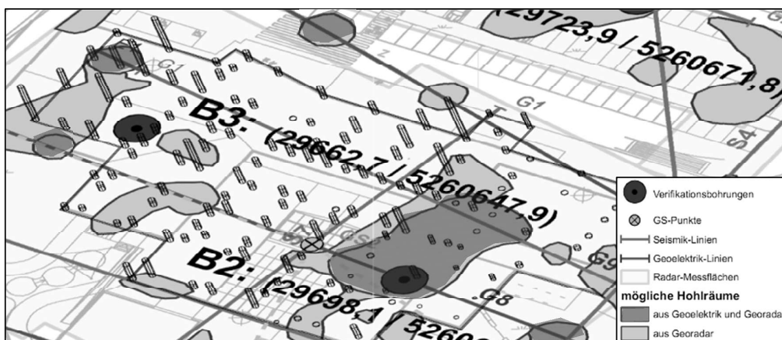
Abb. 10: Vermutete Hohlräume und tatsächlicher Mehrverbrauch an Beton
