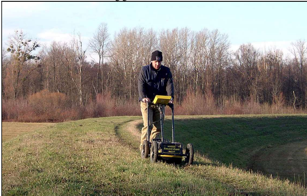
Abb.: 1: Vorerkundung mittels Georadar auf einem Donauhochwasserschutzdamm
