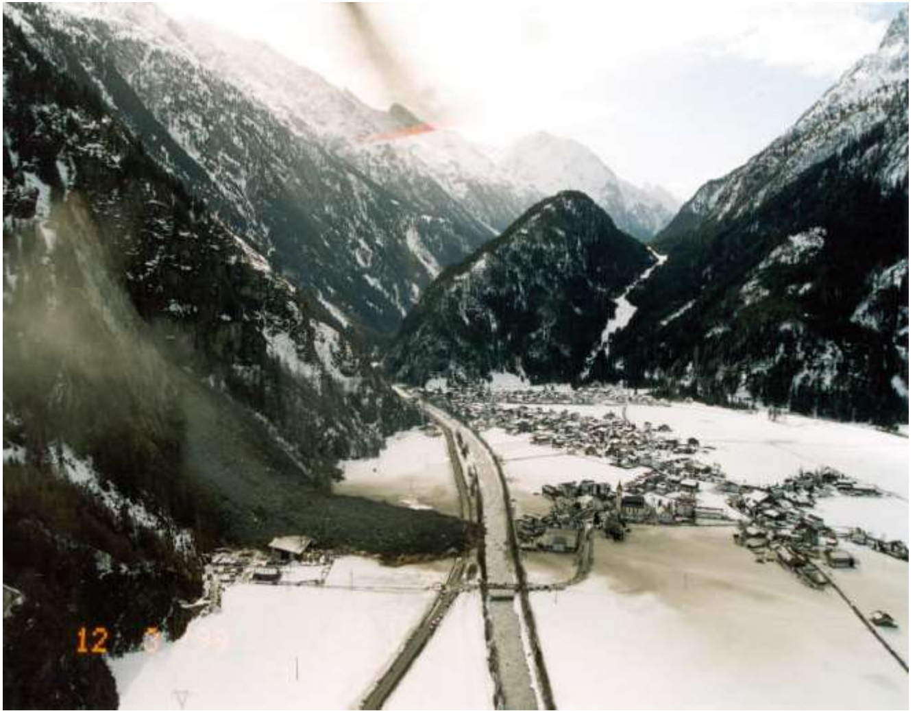
Foto 3: Bergsturz von Huben, Gemeinde Längenfeld/Ötztal am 11.03.2001: Etwa 200.000 m 3 Festgestein verschütten den Großteil eines Sägewerkes und die Ötztal-Bundesstraße. Auch die Stromversorgung für die mit Fremden voll belegten Hotels der Gemeinde Sölden und die gesamten Lifтанlagen ist unterbrochen Die Staubfahne überzieht einen Großteil des Ortes. Es gilt für die Behörde (Bezirkshauptmannschaft Imst) und ihre Sachverständigen rasch zu entscheiden, in welcher Art weitere Gefahr drohen könnte, beziehungsweise ob mit der Wiederherstellung der Straßenverbindung und der Stromleitungen begonnen werden kann.
