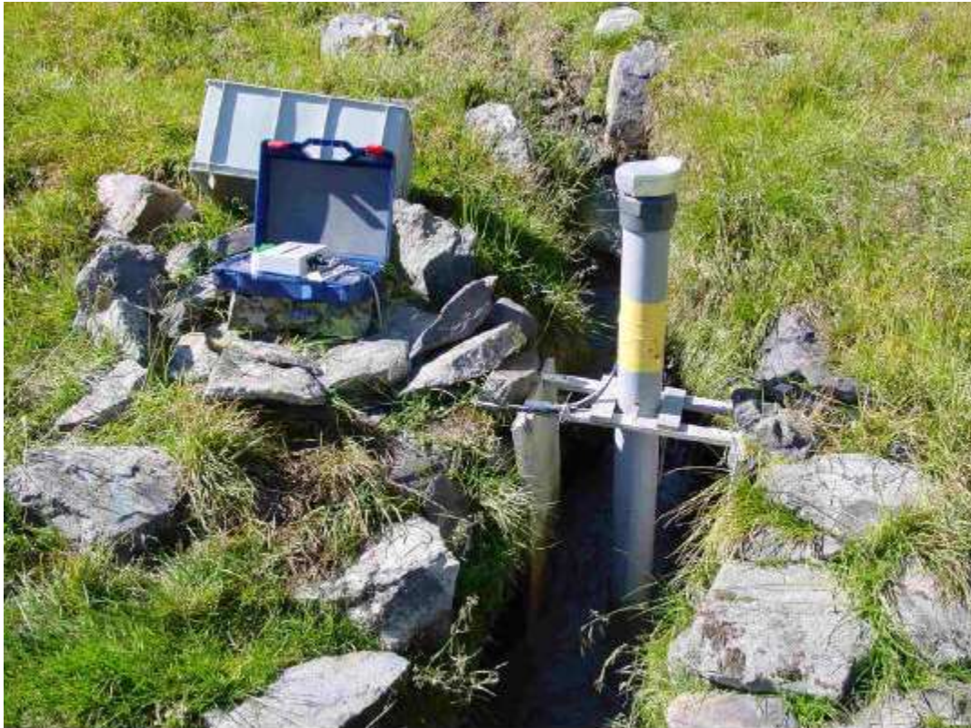
Abbildung 7: Automatische Registrier- und Datensammlereinheit für Druck-, Leitfähigkeits- und Temperatursonden
