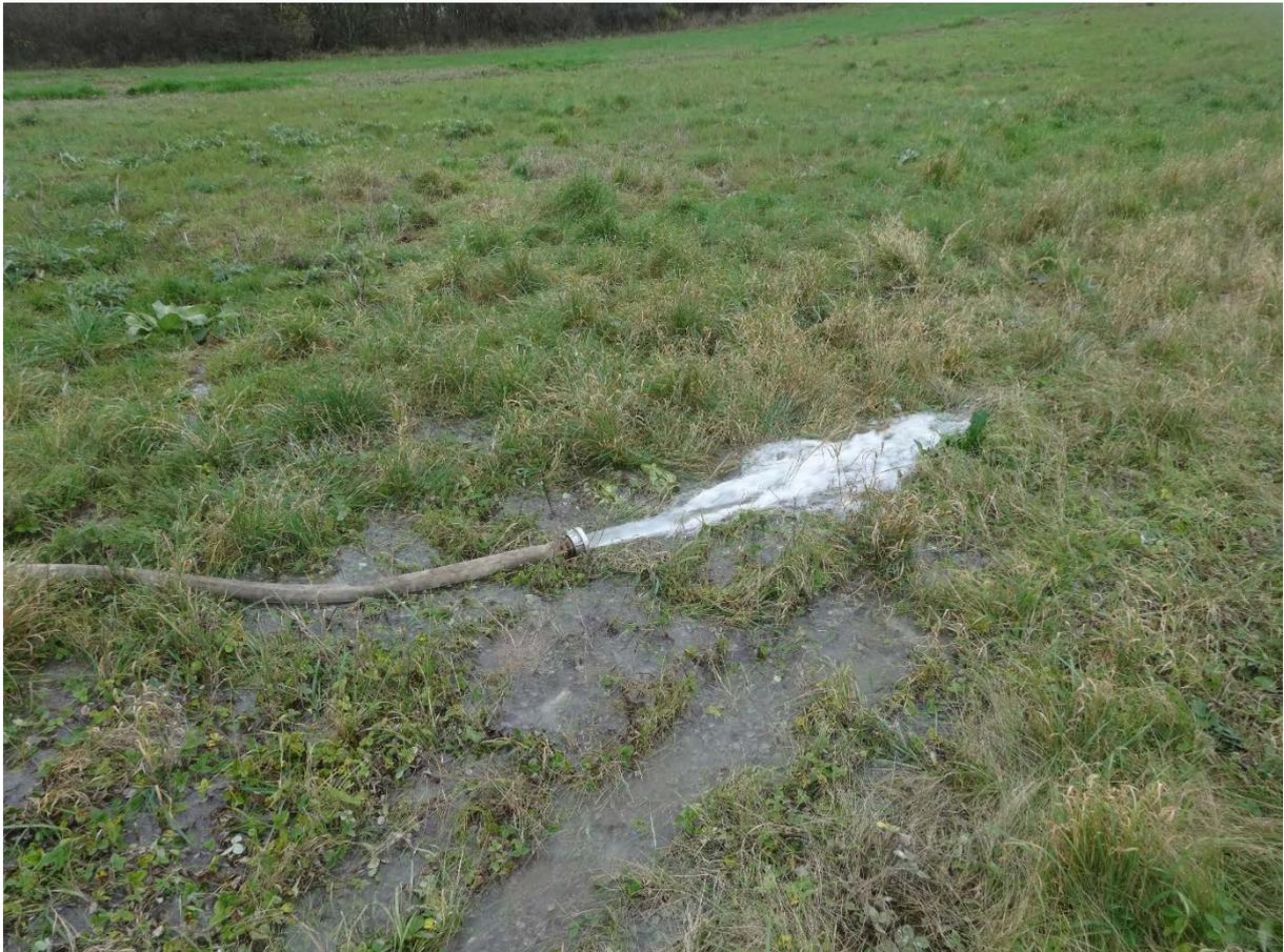
Abb. 4.45: Förderrate von 7 l/sec, Langzeitpumpversuch Fa. Eder
