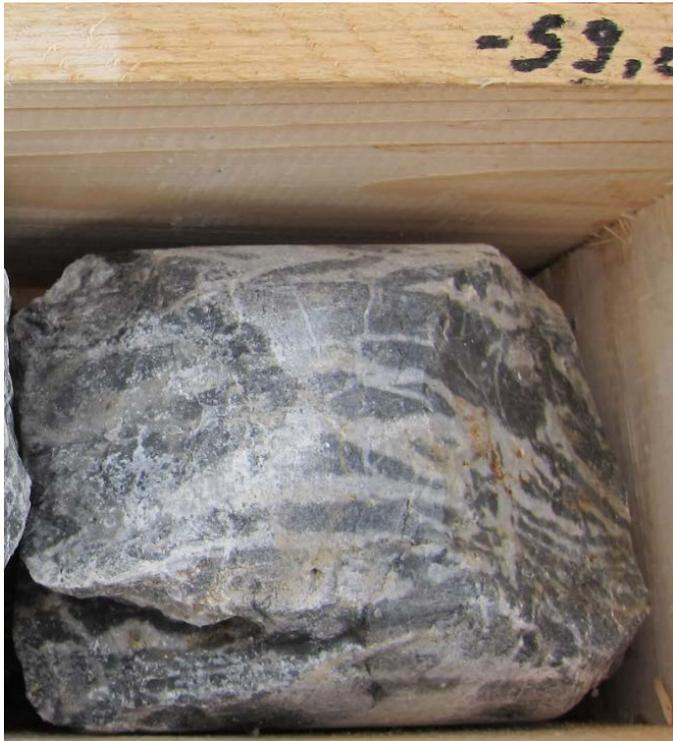
Abb. 4.20: Dolomitbreckzie mit verfüllten Klüften aus Calcit, Bohrkern aus Bohrmeter 59
