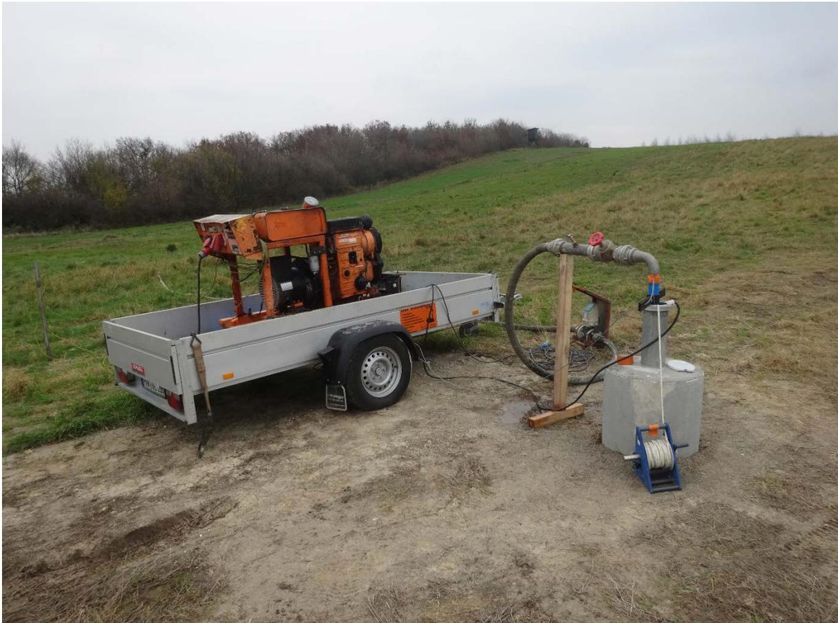
Abb. 4.44: Durchführung Pumpversuch Fa. Eder
