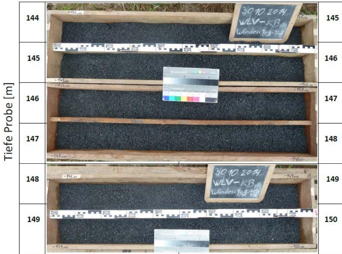
Abb. 4.22: Fotodokumentation der Bohrkisten Erkundungsbohrung EKB01/Winden (GBA)
