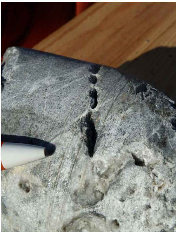
Abb. 4.19: hellgraue Dolomitmikrobrekzie mit Verkarstungserscheinungen in Form von Klüften und Hohlräumen, zum Teil sekundär mit Calcit-Kristallen verfüllt
