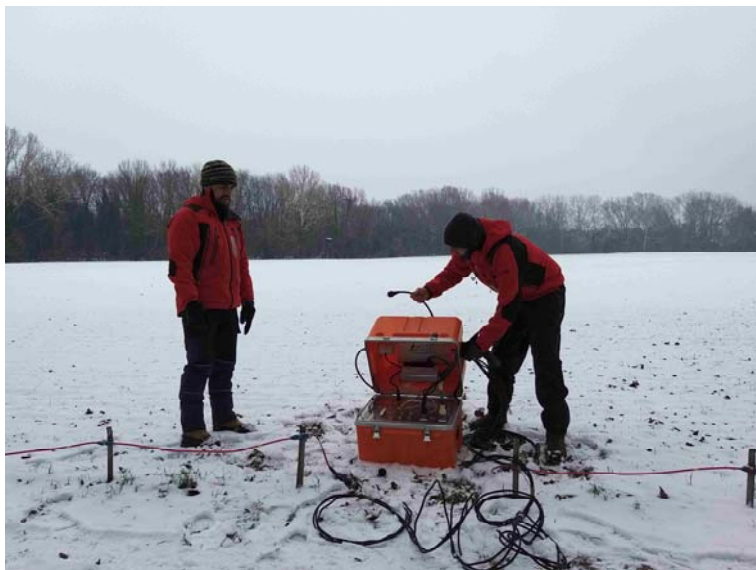
Abb. 1: Einsatz des GEOMON4D-IP Messgerätes (Dezember 2020)
