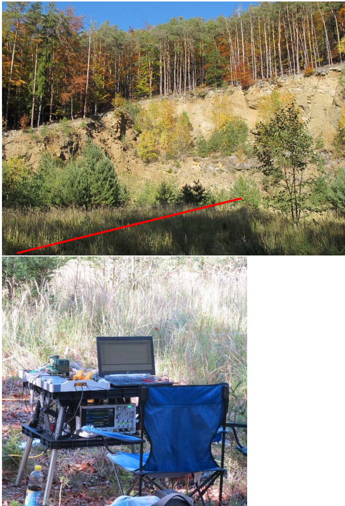
Abb. 8 Situationsfotos der Testmessung Amstall, Foto der Abbaugrube mit eingezeichneten Profilverlauf (oben), Prototyp GEOMON4D-IP inklusive Oszilloskop und Notebook (unten)
