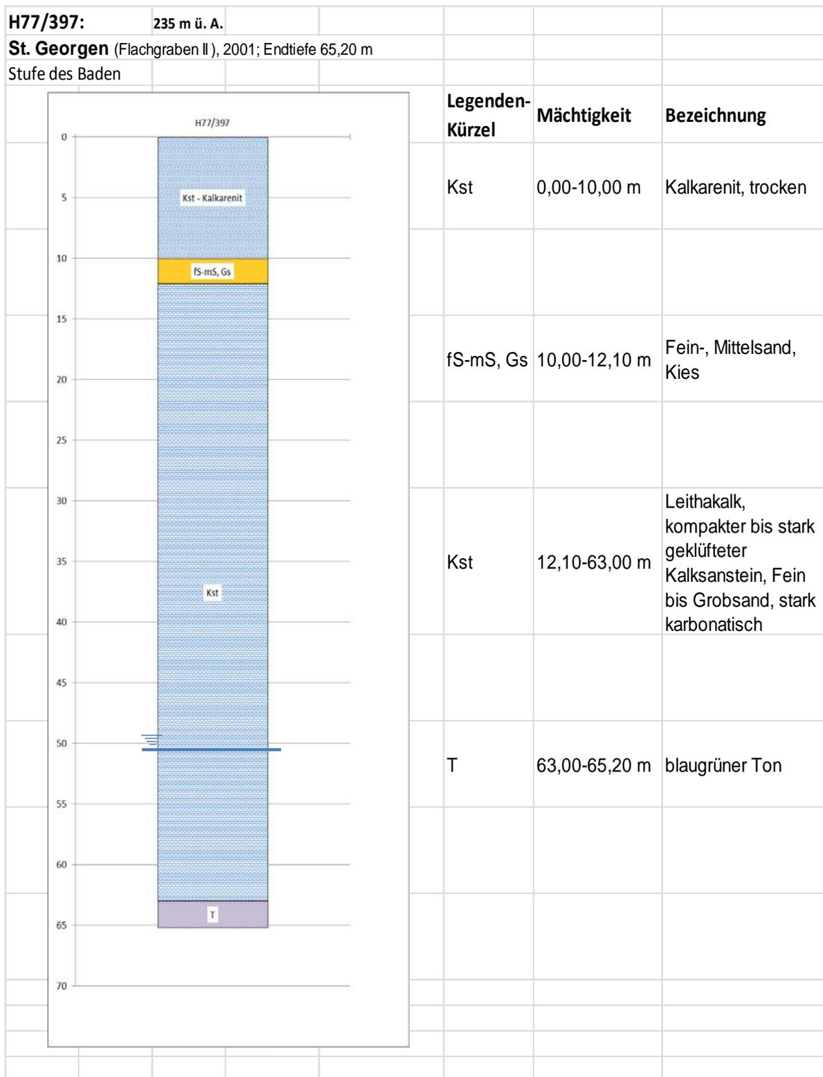
Abb. 3.5: Bohrung H77/397, Flachgraben II, der Fa. Moser aus St. Georgen. Der Grundwasserspiegel liegt auf 50,43 m unter der Geländeoberkante, gemessen am 08.11.2012.
