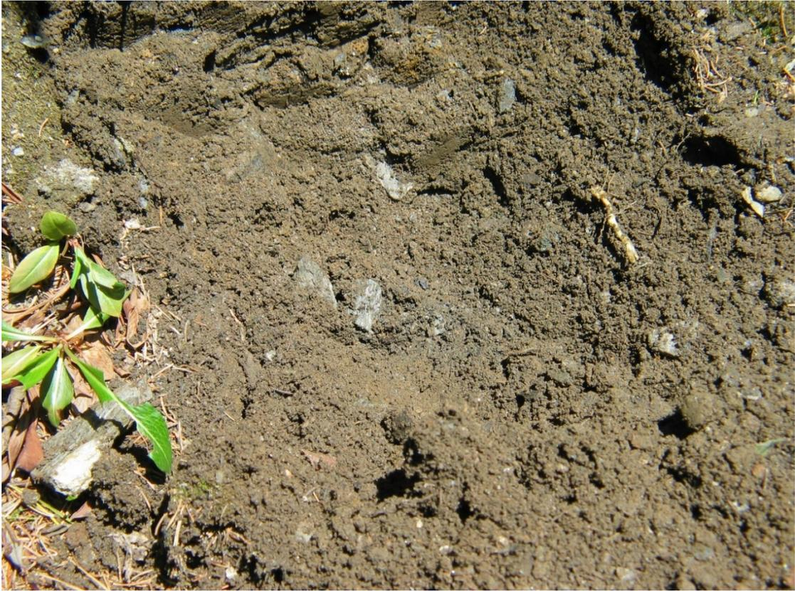
Abb. 24: Feinkörniger, stark verwitterter Aufbereitungsabgang, teilweise mit Grobkomponenten; SW-Rand der Aufbereitungshalde
