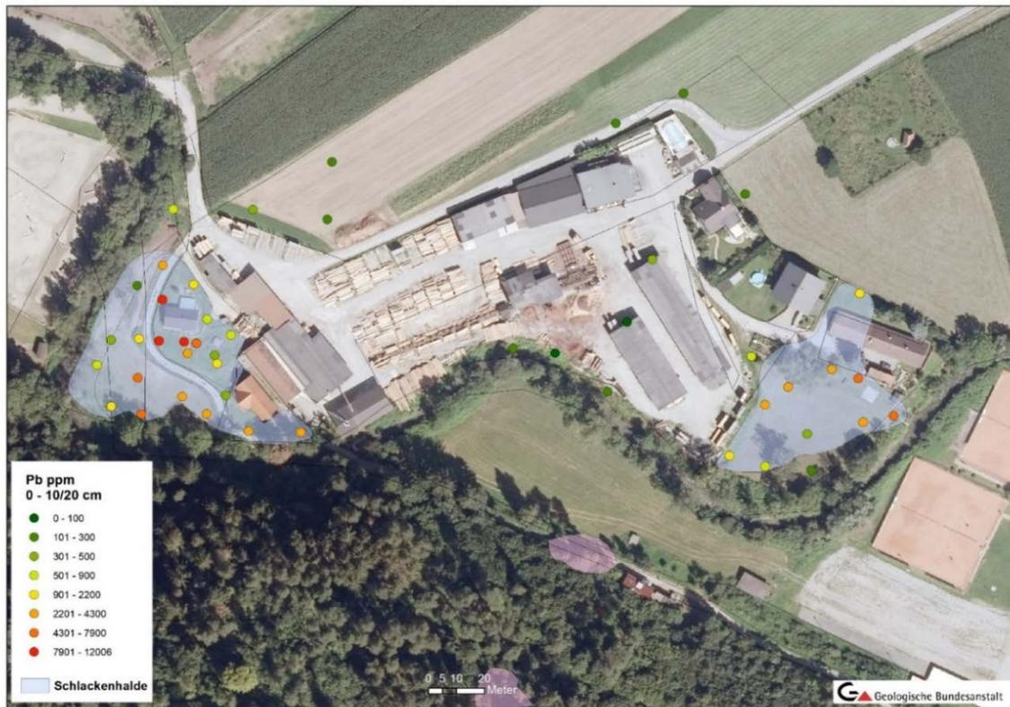
Abb. 7: Geochemische Kartierung im Bereich der Blei-Silber-Schmelzhütte Deutschfeistritz; Elementverteilungskarte für Blei (ppm) im Profilabschnitt 0-10/20 cm (Quelle: ALSAG Voruntersuchungen; SCHEDL et al. 2018)
