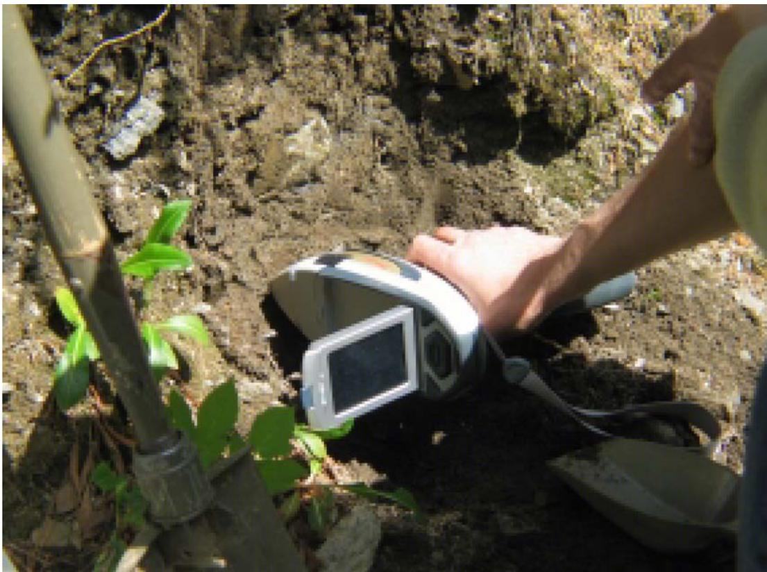
Abb. 27: Beprobter Profilschnitt SW-Bereich der Aufbereitungshalde; in situ-Messungen mittels mobiler RF
