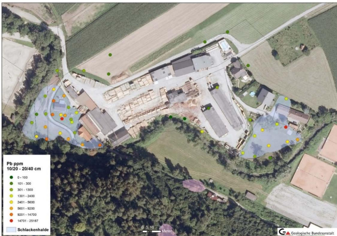
Abb. 8: Geochemische Kartierung im Bereich der Blei-Silber-Schmelzhütte Deutschfeistritz; Elementverteilungskarte für Blei (ppm) im Profilabschnitt 10/20-20/40 cm. (Quelle: ALSAG Voruntersuchungen; SCHEDL et al. 2018)
