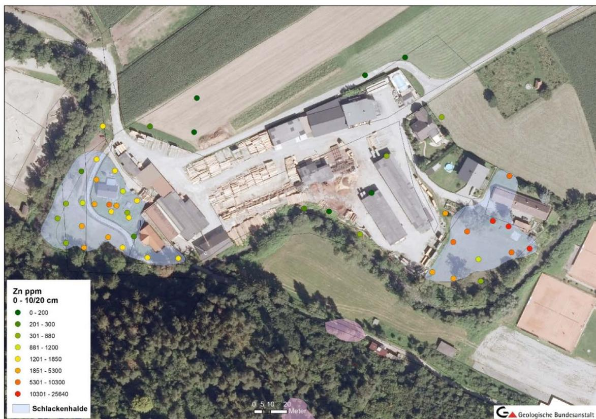
Abb. 9: Geochemische Kartierung im Bereich der Blei-Silber-Schmelzhütte Deutschfeistritz; Elementverteilungskarte für Zink (ppm) im Profilabschnitt 0-10/20 cm. (Quelle: ALSAG Voruntersuchungen; SCHEDL et al. 2018)
