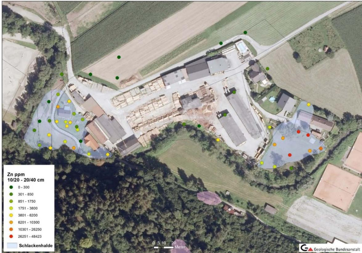
Abb. 10: Geochemische Kartierung im Bereich der Blei-Silber-Schmelzhütte Deutschfeistritz; Elementverteilungskarte für Zink (ppm) im Profilabschnitt 10/20-20/40 cm. (Quelle: ALSAG Voruntersuchungen; SCHEDL et al. 2018)
